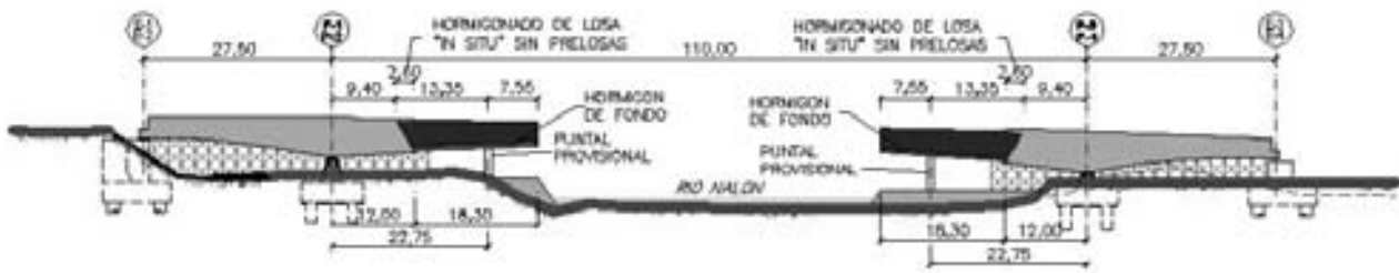
Figura 12. Ejecución de vanos laterales en hormigón y colocación del primer tramo metálico apeado.
