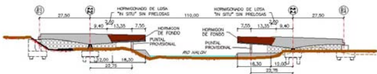
Fig. 7: Ejecución de vanos laterales en hormigón, y colocación del primer tramo metálico apeado.
