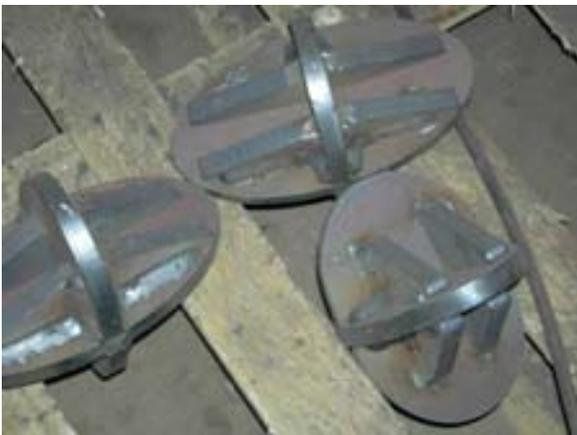
*Fig. 4 Chapas de rigidización y respaldo en uniones "X"*
