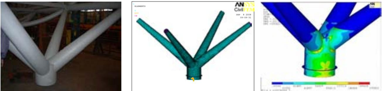
Fig. 20 Modelo y tensiones en unión de brazos de pilas
