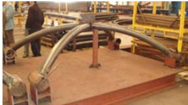
*Fig. 23 Útil para el punteado de tubos*
