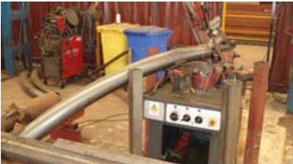
*Fig. 22 Útil para el corte de tubos*
