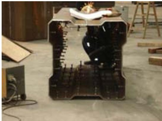
*Fig 11- Semi-sección de arco en taller*
