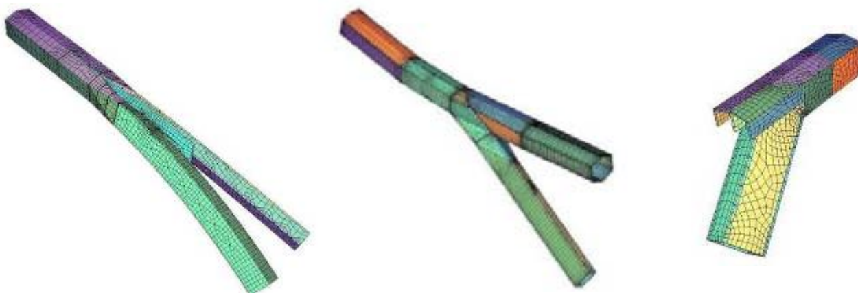
Fig.5 Vista de los modelos de cálculo empleados para el cálculo de dos de los nudos de unión entre patas y cordón superior realizados con el programa SOFISTK.
