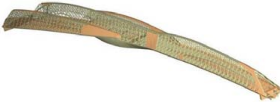
Fig.4 Vista del modelo de cálculo de elementos finitos tipo barra y tipo placa con el programa SOFISTK.
