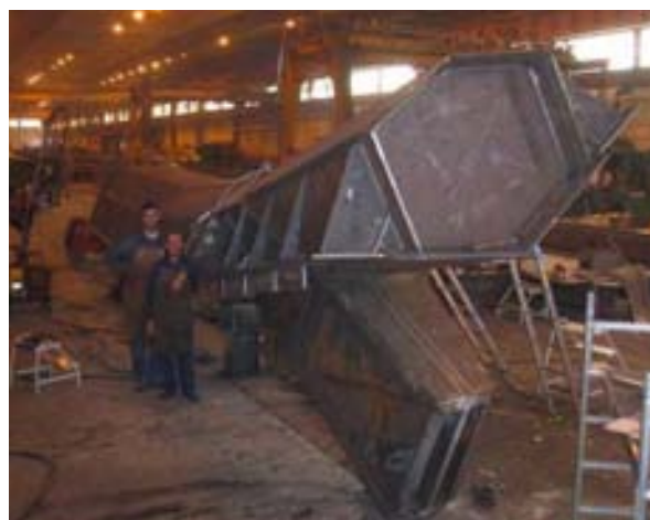
Fig.6 Imágenes del montaje en los talleres de URSSA de dos de los nudos de unión entre patas y cordón superior.
