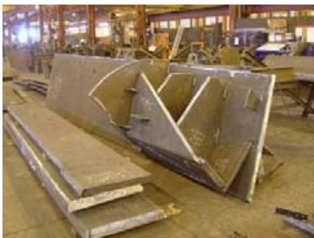
Fig.6 Imágenes del montaje en los talleres de URSSA de dos de los nudos de unión entre patas y cordón superior.
