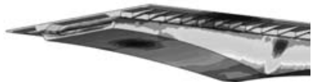
Figura 23. Tensiones globales en el tablero con el vehículo excéntrico.
