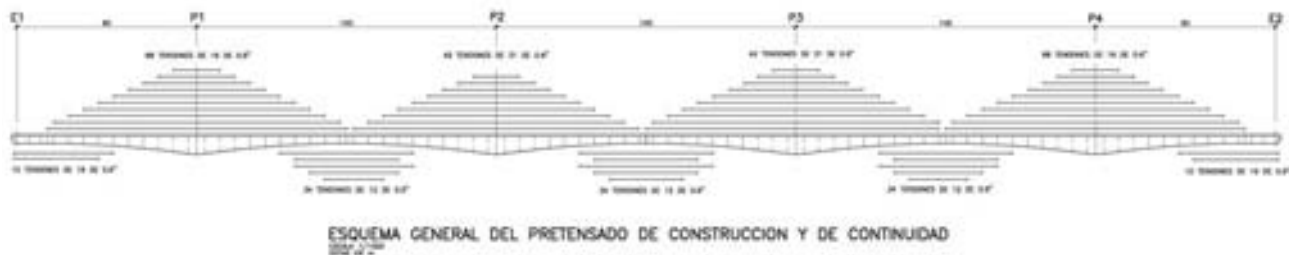
Fig. 6 Esquema de pretensado longitudinal
