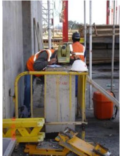
Fig. 2 – Bases fijas de replanteo. Posición y detalle
