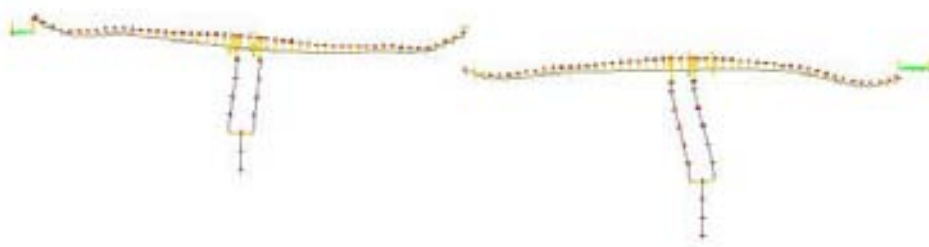
Fig. 26. Flechas producidas por el proceso constructivo.
