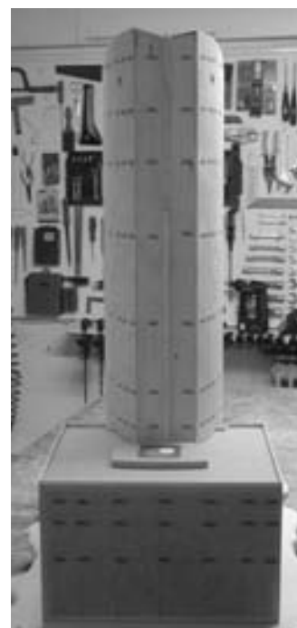
Figuras 18, 19, y 20. Vista frontal, lateral y trasera de la maqueta realizada del Hotel Vela para el ensayo del túnel de viento (1).
