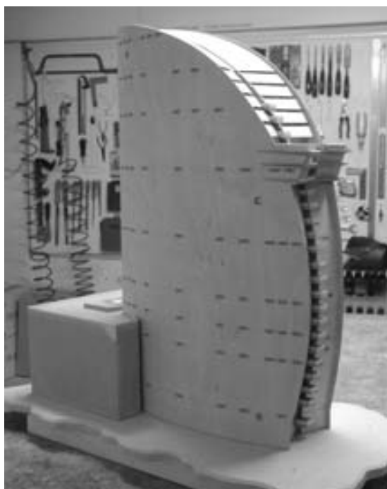
Figuras 18, 19, y 20. Vista frontal, lateral y trasera de la maqueta realizada del Hotel Vela para el ensayo del túnel de viento (1).
