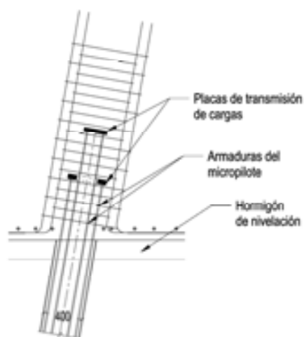
Fig.3. Micropilote: sección ongitudinal y jaula de armado
