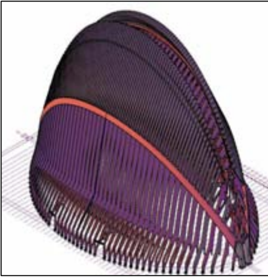
Fig. 4 Vista en perspectiva del modelo CAD de la estructura con la cubierta móvil cerrada
