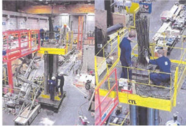
*Ilustración 5.- Ensayos de fatiga anclaje BBR Cona Stay 91Ø0,6"*
