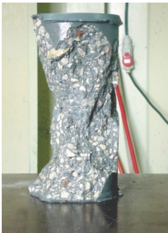
Figura 3.4.2 Probeta cilíndrica 16 x 32 cm después del ensayo a compresión.
