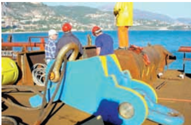
Fig. 5.2.11. Vista del equipo Stevtensionner para control de la puesta en tensión de las cadenas.
