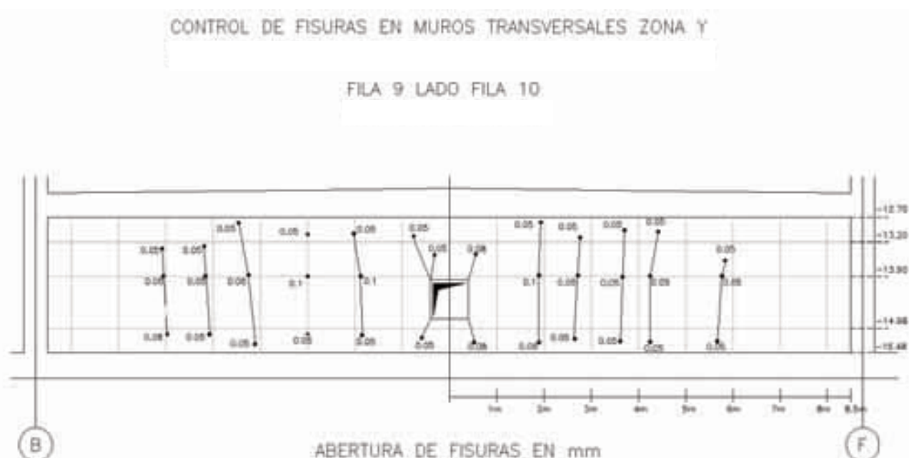
Figura 5.6.2. Fisuras obtenidas en un muro transversal con abertura de paso.
