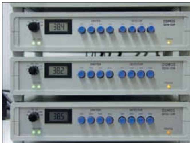
Figura 5.7.4. Unidades optoelectrónicas Opto-Box . A la derecha pueden verse las 10 unidades utilizadas, dispuestas en el armario de centralización de medidas y con los sensores conectados.
