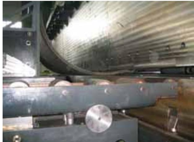
Fig. 7 Preparación de bordes y proceso de doblado de las chapas para los arcos de la cubierta
