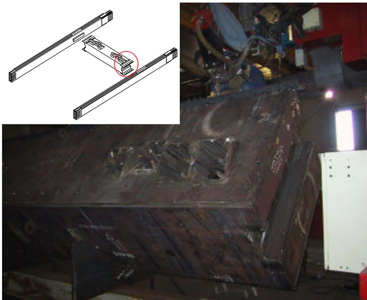
Figura 13. Detalle llave de cortante en riostra.
