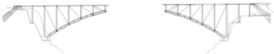
Figura 3. Proceso de construcción de avance por voladizos con diagonales temporales.
