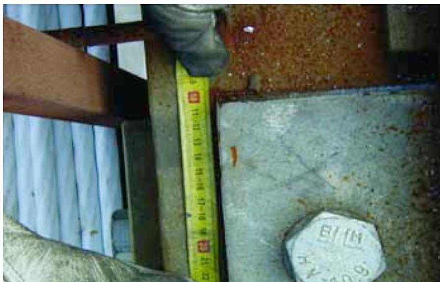
Figura 22. Primer deslizamiento de la unión.
