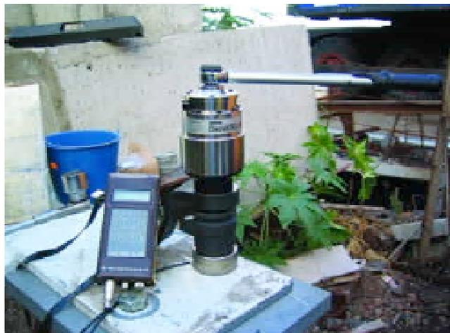
Figura 27. Ensayo con célula de carga.
