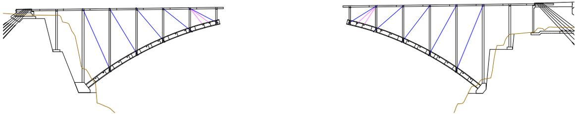
figura 8. Esquema de construcción con diagonales temporales
