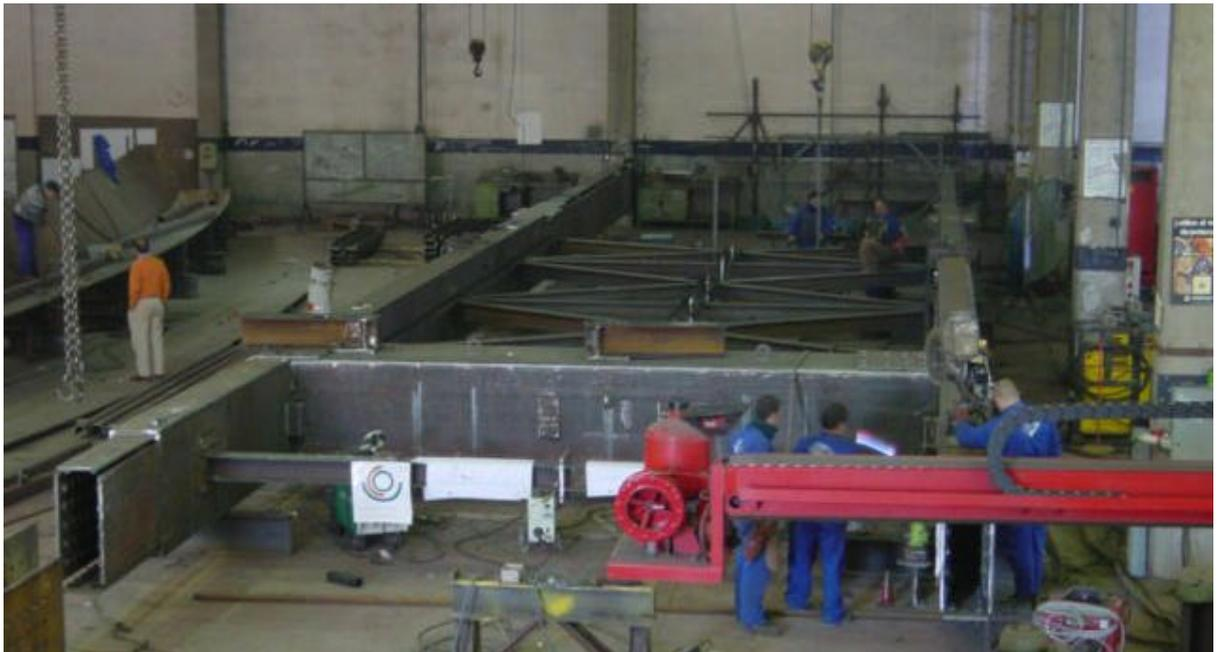
Figura 14. Montaje en blanco del tablero en el taller
