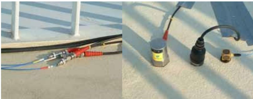
**Figura 14. Acelerómetros e instrumentación**
