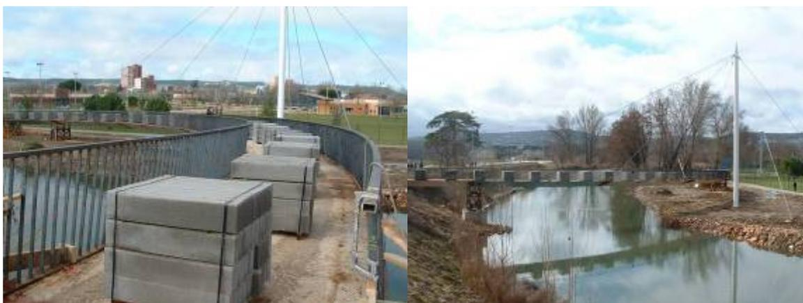
Figura 13. Prueba de carga estática
