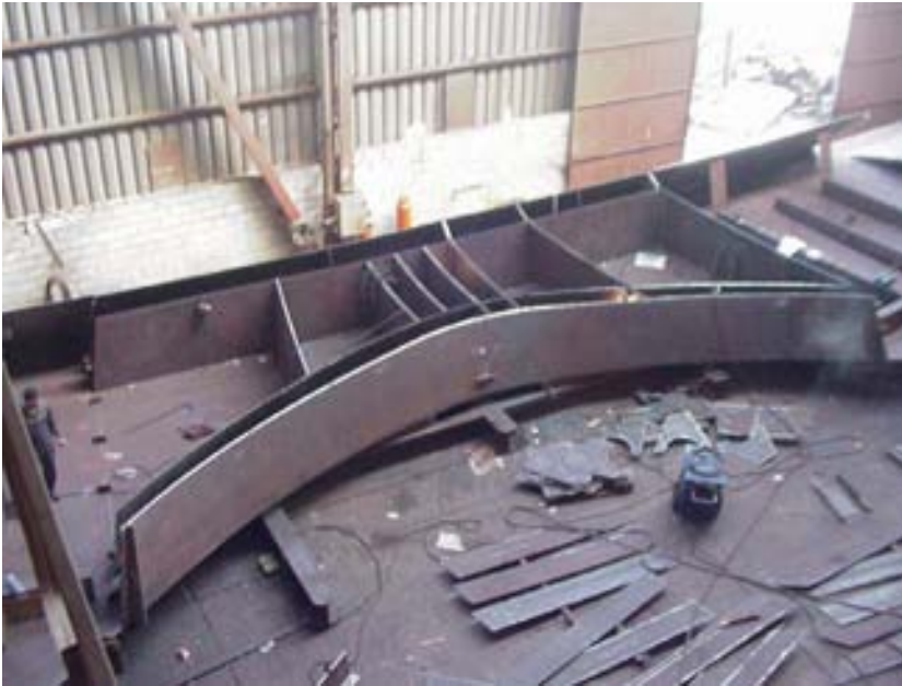
Fig. 10 Montaje de la Pieza de Clave en taller
