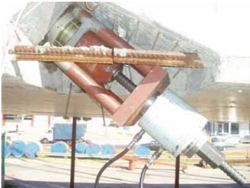
**FOTO 7. Detalle de equipo de tesado multi-torón**
