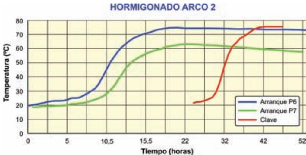
Figura 21. Evolución de las temperaturas del hormigón en arco 2.
