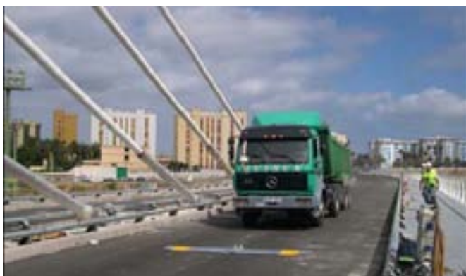
Fig.22 Camión pasando sobre el tablán Rilem durante la prueba de carga dinámica.
