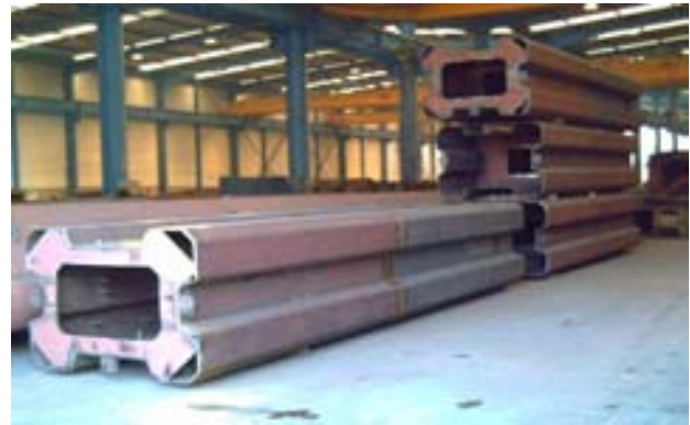
Fig 22. Tramos del arco en taller, listos para el transporte.
