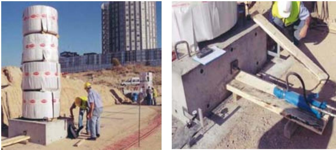
**Figura 5.a y 5.b Ensayo a pequeña escala del coeficiente de rozamiento entre la losa de cimentación y el terreno**
