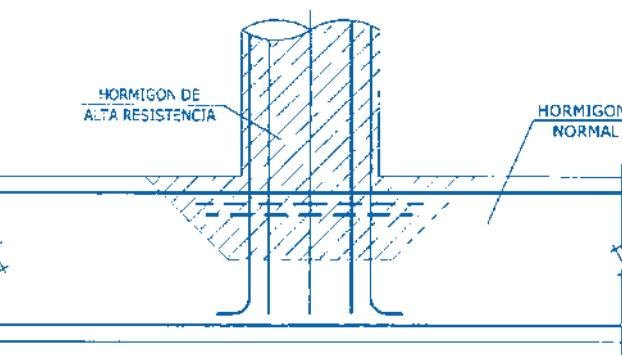
Figura 11. Arranque de soportes.
