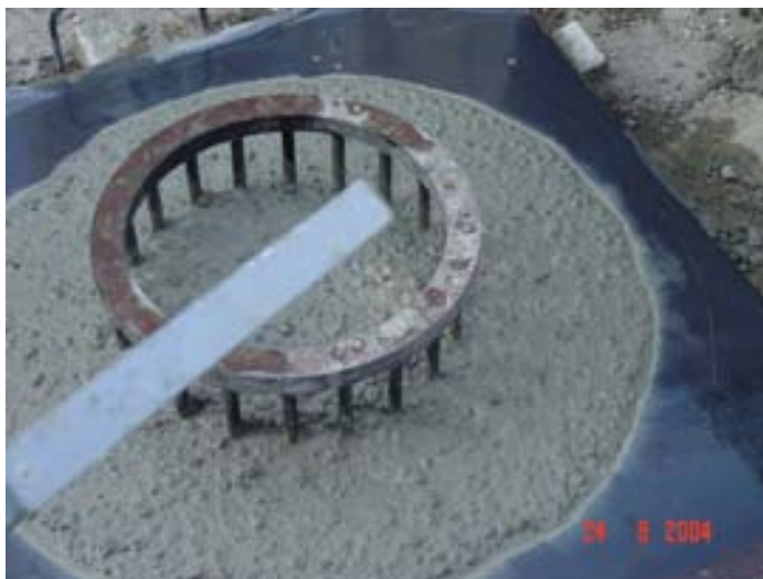
Figura 1. Ensayo de Anillo J
