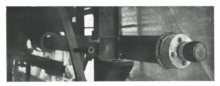
FOTO N.º 4.-La máquina de moldear lleva un árbol central giratorio que cumple tres misiones distintas, que son: 1.º Soportar el molde durante el vertido. 2.º Hacer girar el molde a 60 r. p. m., por rozamiento con el borde interior de los aros extremos. 3.º Comprimir el hormigón de las paredes de la tubería.
