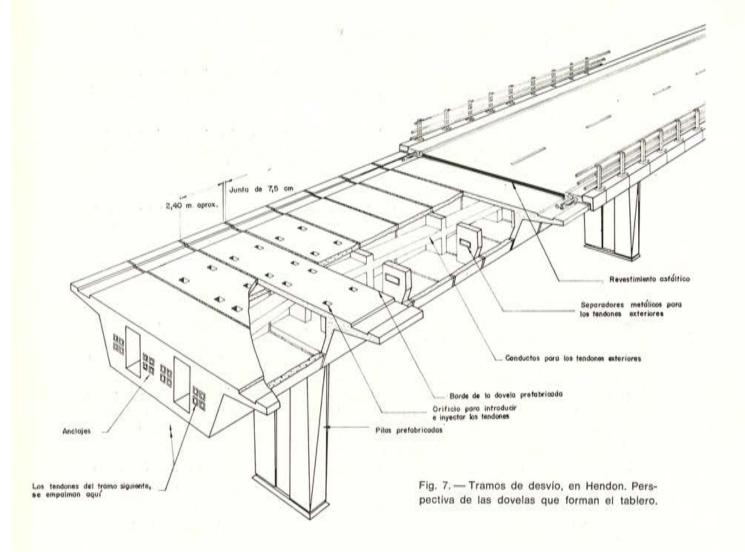
La junta de tipo normal entre dovelas está formada por una capa de hormigón fino, de un espesor aproximado variable entre 7,5 y 12,5 cm.
