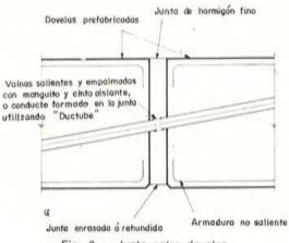
Fig. 8. - Junta entre dovelas.
