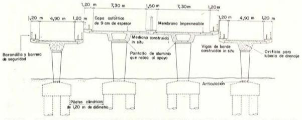
Fig. 12. — Paso elevado de Mancunian Way, en Manchester. Sección transversal de la estructura con doble calzada de dos carriles y rampas de acceso.
