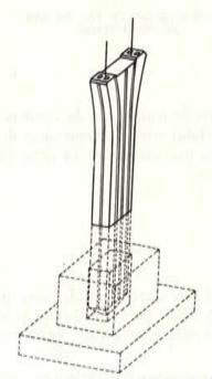
3. - PILA PARA MONTAJE DE DINTEL
