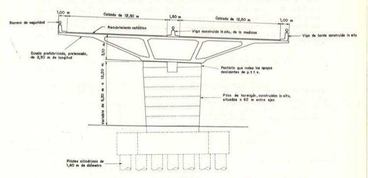
Fig. 23. — Paso elevado de Westway, en Londres. Sección transversal de la viga principal, construida por dovelas.
