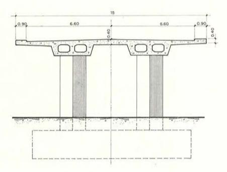
Figura 4. - Sección transversal por el centro de un tramo (cotas en m).
