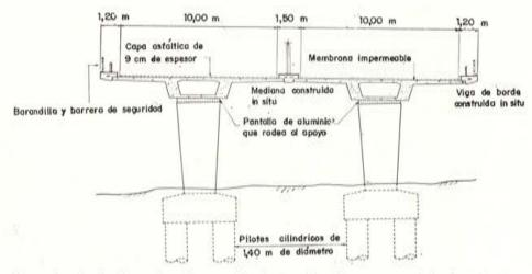
Fig. 11. — Paso elevado de Mancunian Way, en Manchester. Sección transversal de la estructura con doble calzada de tres carriles.
