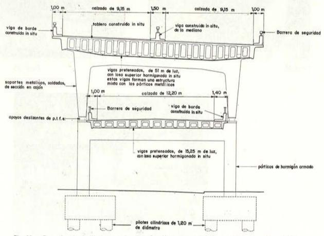
Fig. 30. — Paso elevado de Westway, en Londres. Sección transversal de la estructura con tablero doble.
