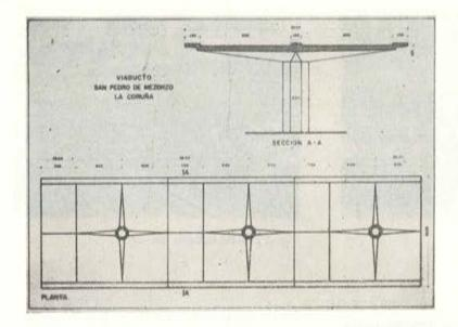
Fig. 16. — Puente de San Pedro de Mezonzo, Planta parcial y sección transversal.
