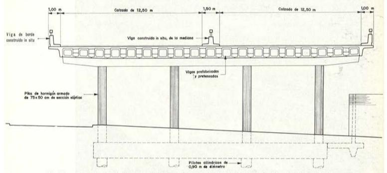
Fig. 22. — Paso elevado de Westway, en Londres. Sección transversal del tramo de 22 m de luz en el cruce de Ladbroke Grove.
