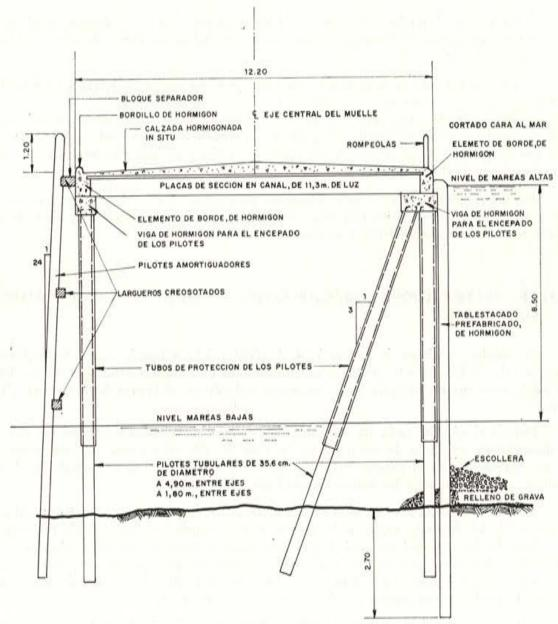
Sección transversal de la estructura del muelle.
