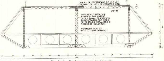
Figs. 3 y 4. — Secciones transversales del puente.
