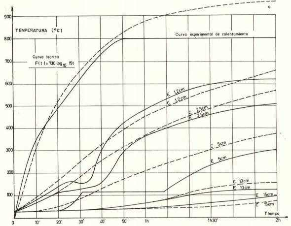
Fig. 84. — Diagramas de reparto de temperaturas en una pared de hormigón.
