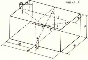
En la figura 85 se representa la disposición de los termopares, las figuras 86 y 87 dan la comparación entre las curvas experimentales (E) relativas a los dos prismas, y las calculadas (C) de acuerdo con el método anteriormente expuesto.
