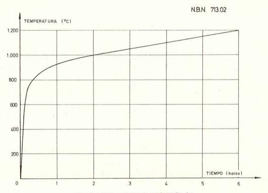
Fig. 1-a. — Curva normal de un incendio tipo.
