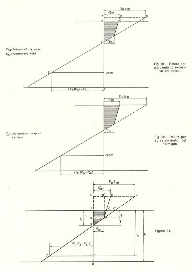
La figura 93 representa el diagrama de reparto de deformaciones para un alargamiento del acero  $\epsilon'_A$  correspondiente a una tensión y a una temperatura dadas.
