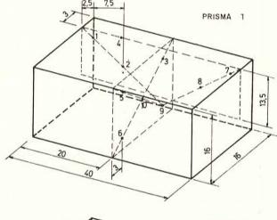
Fig. 85. — Disposición de los termopares.
