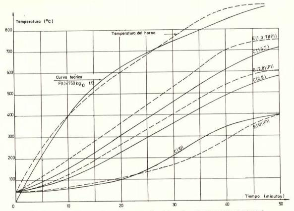
Fig. 86. — Comparación entre los valores experimentales y los calculados para el prisma 1.
