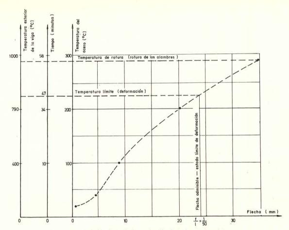
Fig. 100. — Evolución de la flecha en función de la temperatura del acero.
