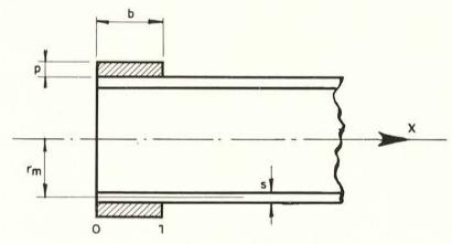
El estudio de este estado de carga puede realizarse basándose en la teoría de las láminas cilíndricas, considerando una presión externa constante, no sólo en dirección radial, sino también en dirección longitudinal, y haciendo variar gradualmente la longitud del segmento inicial del tubo, sobre el cual se aplica la presión externa.
