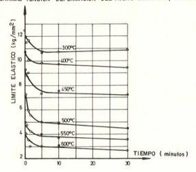
INFLUENCIA DEL TIEMPO DE PUESTA EN CARGA SOBRE EL LIMITE ELASTICO DEL ACERO EN FUNCION DE LA TEMPERATURA
