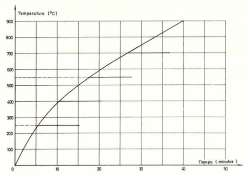
Fig. 67. - Curvas de calentamiento de los hormigones.
