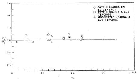
Fig. 7. — Momentos deducidos de  $M_c' = q_u$  (1 — 0,9  $q_u$ ), donde  $q_u = (q_c + \lambda)$  (1 + 2  $\lambda$ ) y  $\lambda = \psi d_1 \varepsilon_u E_s r/u L$  (ensayos independientes).
