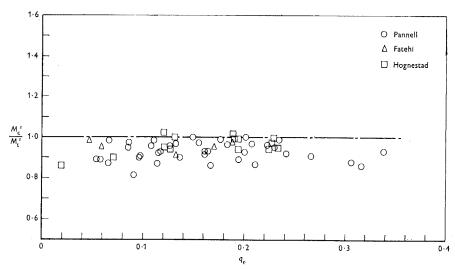
Fig. 8.—Cálculos del lado de la seguridad al utilizar  $M'_c = q_u$  (1 —  $q_u$ ) y  $\Psi \epsilon_s E_s = 7000 \text{ N/mm}^2$ , es decir,  $\lambda = 7000 \text{ rd}_1/u L$ .
