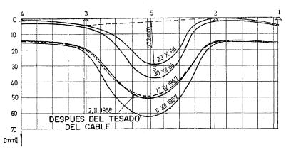
Fig. 3. — Fiechas relativas de la viga longitudinal a lo largo del tiempo, antes de la reparación (líneas llenas) y después (líneas de puntos).
