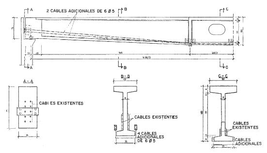
Fig. 7. — Detalles de la reparación de una viga de cubierta, de hormigón pretensado, de luz igual a 14,90 m introduciendo cuatro cables adicionales de 6 Ø 5, de acero 140/165.
