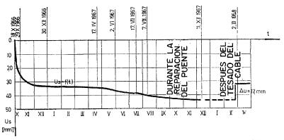
Fig. 4. — Flechas de la viga en el ventro del puente, antes y después de la reparación. Inmediatamente después del tesado, la parte central subió 12 mm.
