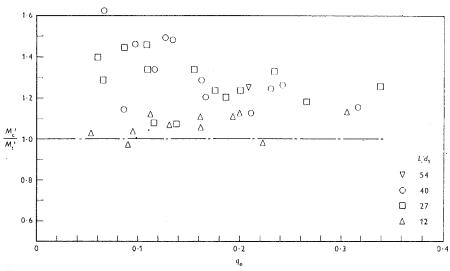
Fig. 3.—Momentos resistentes, según la teoría de Hognestad. Parámetros supuestos:  $\alpha=0.67; \qquad \beta=0.63; \qquad \epsilon_{_{\mathcal{U}}}=0.30; \qquad \textit{F}=\textit{n}.$
