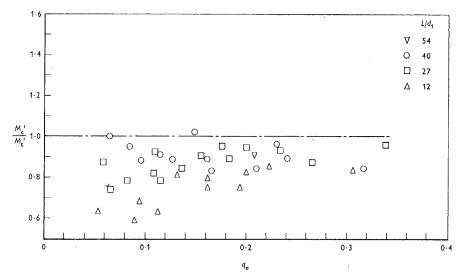
Fig. 2.—Momentos resistentes, según la teoría de Baker, Parámetros supuestos:  $\alpha=0,4; \qquad \beta=1,0; \qquad \varepsilon_u=0,2; \qquad F=0,1.$
