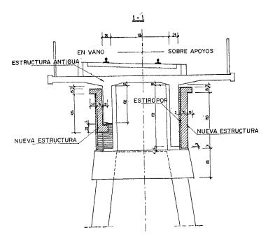
Fig. 5. — Sección transversal del puente de ferrocarril en la línea Petrovaradin-Beocin.
