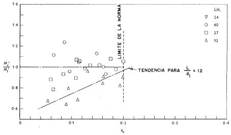
Fig. 4.—Momentos resistentes según la norma CP 115. Parámetros supuestos:  $\beta = \text{1,0}; \qquad q_u = \textit{C}\,q_e.$
