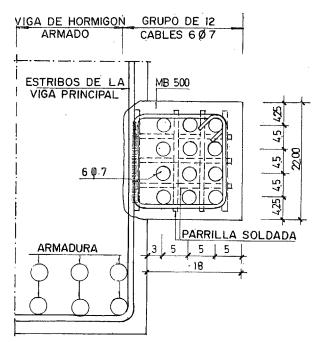
Fig. 2. — Sección transversal de un grupo de 12 cables 6 Ø 7, y su unión a la viga de hormigón armado.
