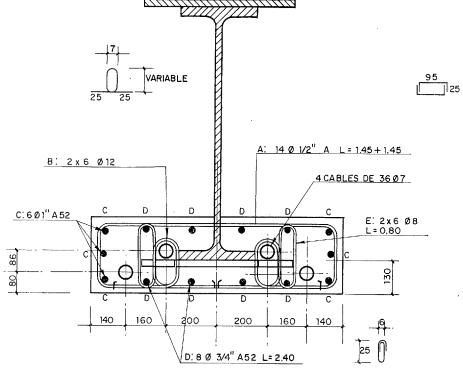
Fig. 4. — Sección transversal de una viga (a 1 m del apoyo).
