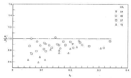
Fig. 2.—Momentos resistentes, según la teoría de Baker. Parámetros supuestos:  $\alpha=0,4; \qquad \beta=1,0; \qquad \epsilon_{\it u}=0,2; \qquad {\it F}=0,1.$
