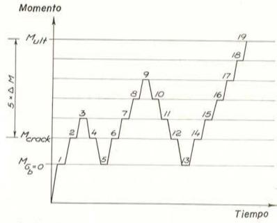
Fig. 26. — Diagrama de ciclos de carga.  $M_{\sigma\,b}=0$  es el momento para el cual es nula la tensión calculada en el hormigón a nivel de la armadura.  $M_{\rm c\,rac\,k}$  es el momento para el que se observa la primera grieta.  $M_{\rm ult}$  es el momento de rotura calculado para las resistencias nominales del hormigón y del acero. Hasta el escalón número 17, se hicieron observaciones en cada escalón. También se pudieron hacer en muchos casos en el escalón 18.
