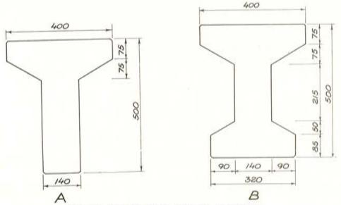
Figura 24. Vigas de ensayo. Secciones transversales.
