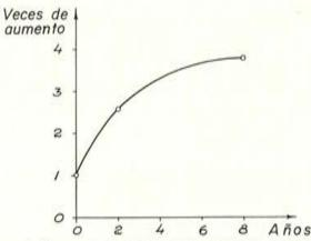
Fig. 2. — Aumento del número de fisuras en el puente sobre el Sagan, en Ostanbro. La tensión en la armadura en el centro de la luz, debida a la carga permanente, es del orden de 1.000 kg/cm².
