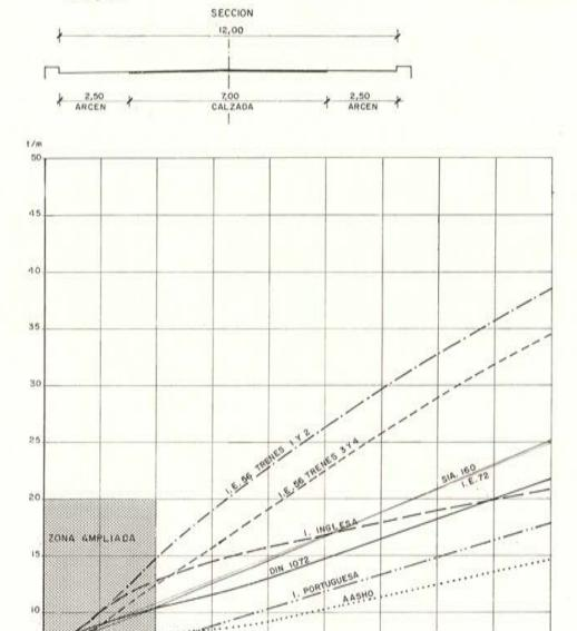
Fig. 3. — Esfuerzos cortantes máximos por metro de ancho.
