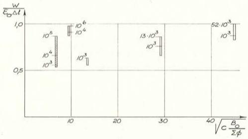
Fig. 16. — Aumento de  $w/\varepsilon_a \cdot \Delta I$  con cargas repetidas para vigas con barras corrugadas. Los números de las columnas son ciclos de carga.
