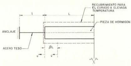
Fig. 1. - Esquema de un banco de pretensado.
