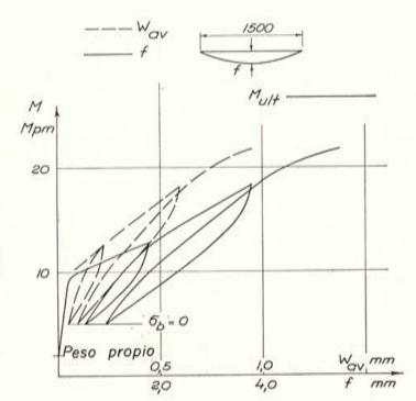
Fig. 12. — Flecha en una longitud de 1,5 m a mitad de la luz y ancho medio de fisura para la viga XIIB de los ensayos proplos.
