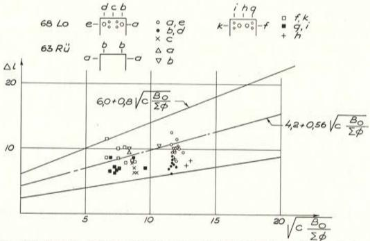
Fig. 8. — Distancia medida entre fisuras en vigas armadas con barras corrugadas de diferente diámetro y recubrimiento variable, comparada con la calculada según las fórmulas (1) y (2).
