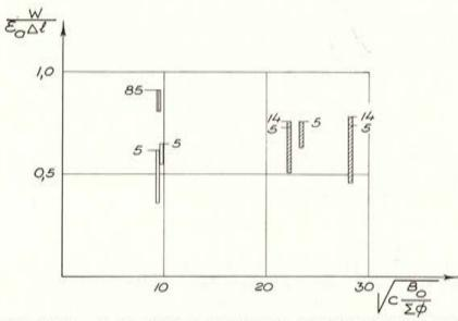
Fig. 17. — Aumento de  $w/\epsilon_a \cdot \Delta I$  con cargas de larga duración para vigas con barras corrugadas. Los números de las columnas son días de carga mantenida.
