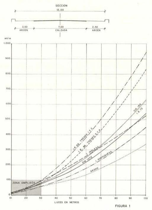
Fig. 1. - Momentos flectores máximos por metro de ancho.
