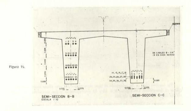
La razón fundamental de esta tendencia recae en la ventaja de operar con unos encofrados más sencillos, y de facilitar al propio tiempo el hormigonado y desmoldeo de las vigas. Es decir, principalmente a razones de tipo constructivo.
