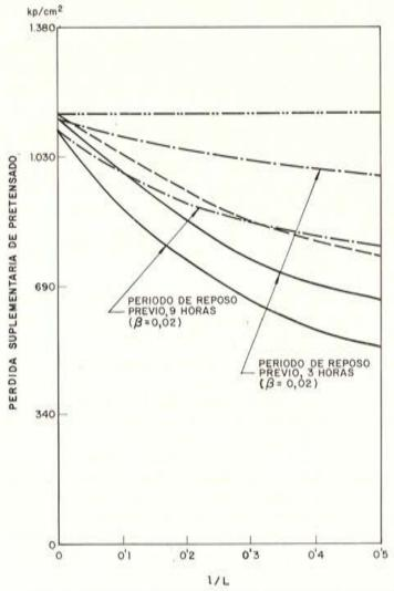
Fig. 3. - Pérdidas suplementarias de pretensado en función de I/L.
