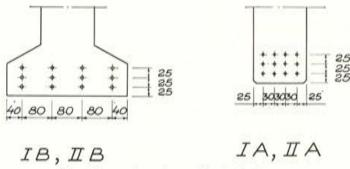
Fig. 25, a. — Armadura ordinaria Ø 10 mm.
