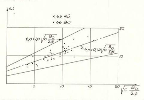
Fig. 6. — Distancia entre fisuras medida en los paramentos laterales de vigas armadas con barras lisas, comparada con la calculada según las fórmulas (4) y (5).
