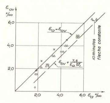
Fig. 14. — Deformación del acero calculada sin considerar el hormigón circundante, comparada con la deformación media a nivel de la armadura, calculada a partir de la curvatura, para la viga XIIB de los ensayos propios.
