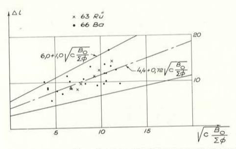
Fig. 7. — Distancia entre fisuras medida en el paramento sometido a mayor tensión (fondo) de vigas armadas con barras lisas, comparada con la calculada según las fórmulas (4) y (5).
