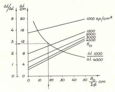
Fig. 1. — Relación entre la distancia entre fisuras, la tensión  $\sigma_a$  y el valor  $\frac{\mathcal{B}_o}{\Sigma \mathcal{O}}$ , según (59 Ef).
