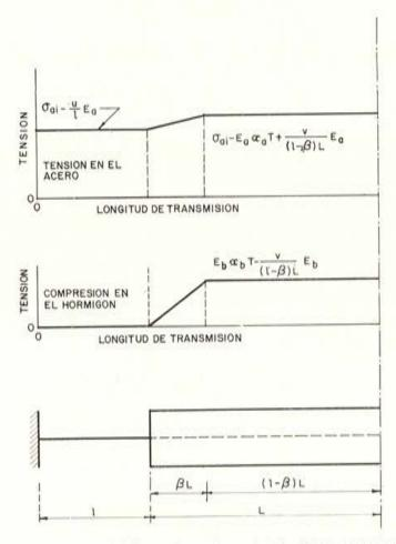
Fig. 2. — Tensiones en los materiales, a temperatura elevada. (Existe adherencia antes del aumento de temperatura.)
