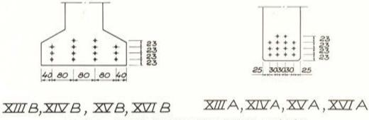
Fig. 25, g. — Alambres Ø 5 mm pretesos, grafilados y ondulados.
