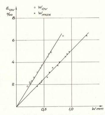
Fig. 13. — Anchuras media y máxima de fisura para la viga XIIB de los ensayos proplos, comparadas con la deformación media a nivel de la armadura, calculada a pertir de la curvatura.
