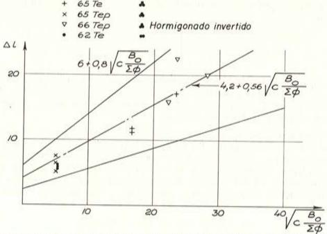
Fig. 9. — Distancia medida entre fisuras en vigas armadas con barras agrupadas comparada con la calculada según las fórmulas (1) y (2).
