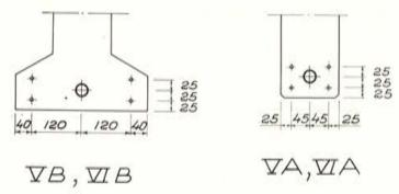
Fig. 25, c. — Barra postesada Ø 26 mm en vaina y barras corrugadas Ø 10 mm.
