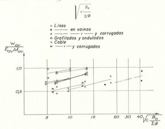
Fig. 15. — Valores de  $w_{av}/\varepsilon_{av} \cdot \Delta I_{av}$  en los ensayos propios. Cinco vigas presentan valores próximos a la unidad. Cuatro de ellas, con alambres lisos grafilados u ondulados, tenían una cuantía menor del 1 por 100 (figura 11) y una viga con alambres lisos de 2,5 mm de diámetro falló por adherencia.
