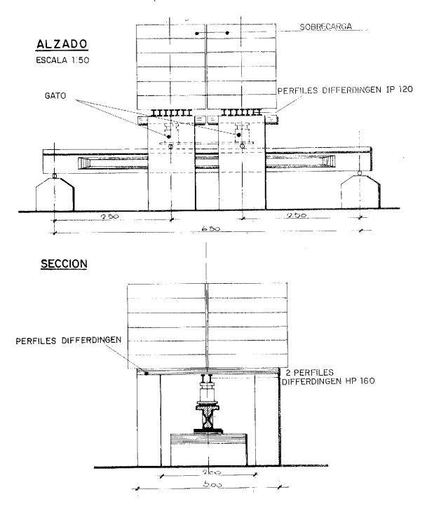
Fig. 6. — Esquema del dispositivo de ensayo.
