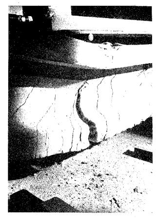
Fotografía 6. — Viga tipo B rota.
