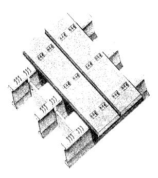
Fig. 1. — Tipo de tablero totalmente prefabricado.
