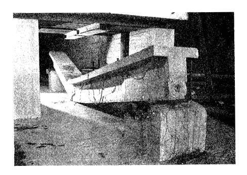
Fotografía 4. — Viga tipo D después de la rotura.
