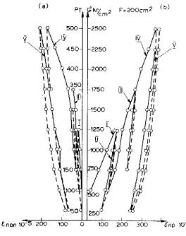
Deformaciones longitudinales y transversales de probetas fabricadas con esferas de Sitall
