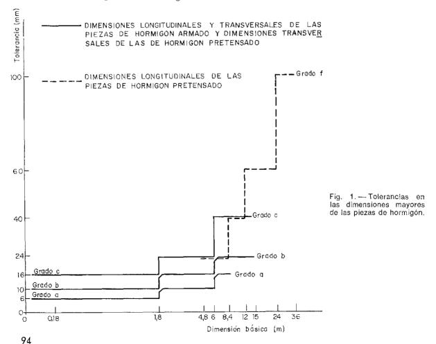
Se señala especialmente que una norma sobre tolerancias dimensionales permitirá mejorar, tanto técnica como económicamente, el proyecto de las uniones entre las piezas de una estructura prefabricada."
