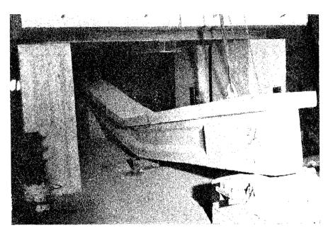
Fotografía 5. — Viga tipo A después de la rotura.
