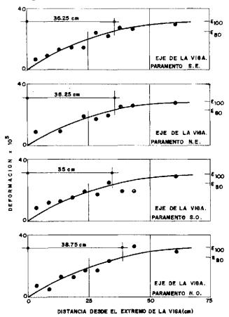
Fig. 3. — Diagramas de deformación, viga Du-13 (destesado brusco; una sola etapa).
