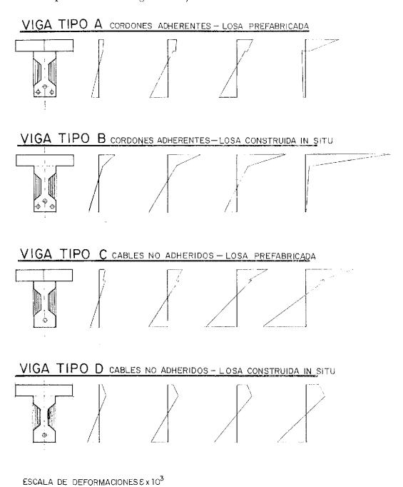
Fig. 9. — Deformaciones de las secciones centrales de los distintos tipos de vigas, en función de las cargas, en toneladas, de 1,33, 2,66, 3,99, 5, 32.
