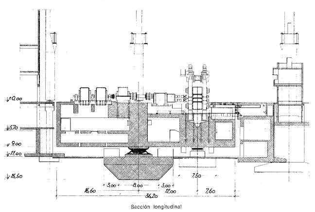
Como ejemplo de todos los problemas expuestos se muestran algunos detalles de la cimentación de un tren continuo de laminación en caliente, construido por la empresa Krupp, en Bochum, Alemania occidental.
