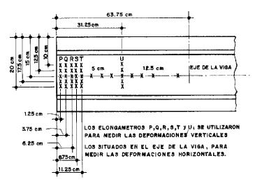
Fig. 2. — Localización de los puntos donde se colocan los elongámetros en los paramentos laterales de las zonas extremas de las vigas.
