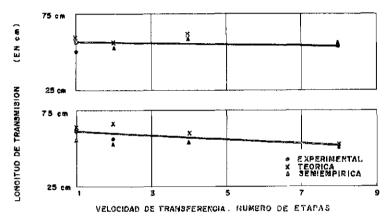
Fig. 4. — Influencia de la velocidad de transferencia en la longitud de transmisión.
