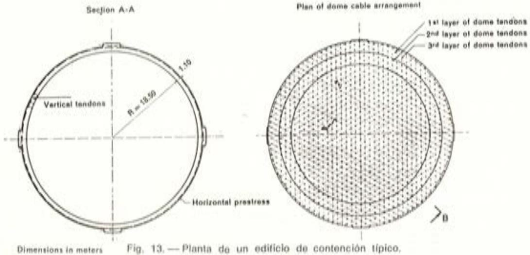
Fig. 13.—Planta de un edificio de contención típico.
