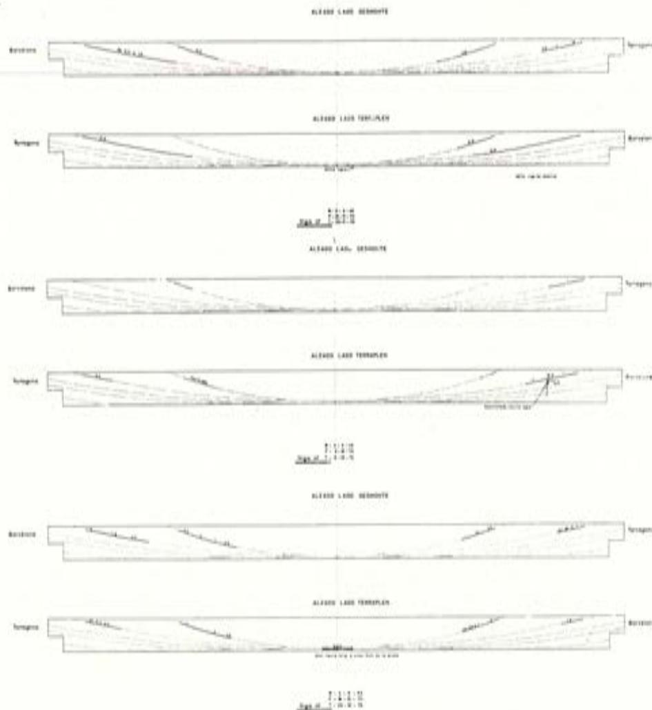
Fig. 3. — Daños típicos en las vigas.
