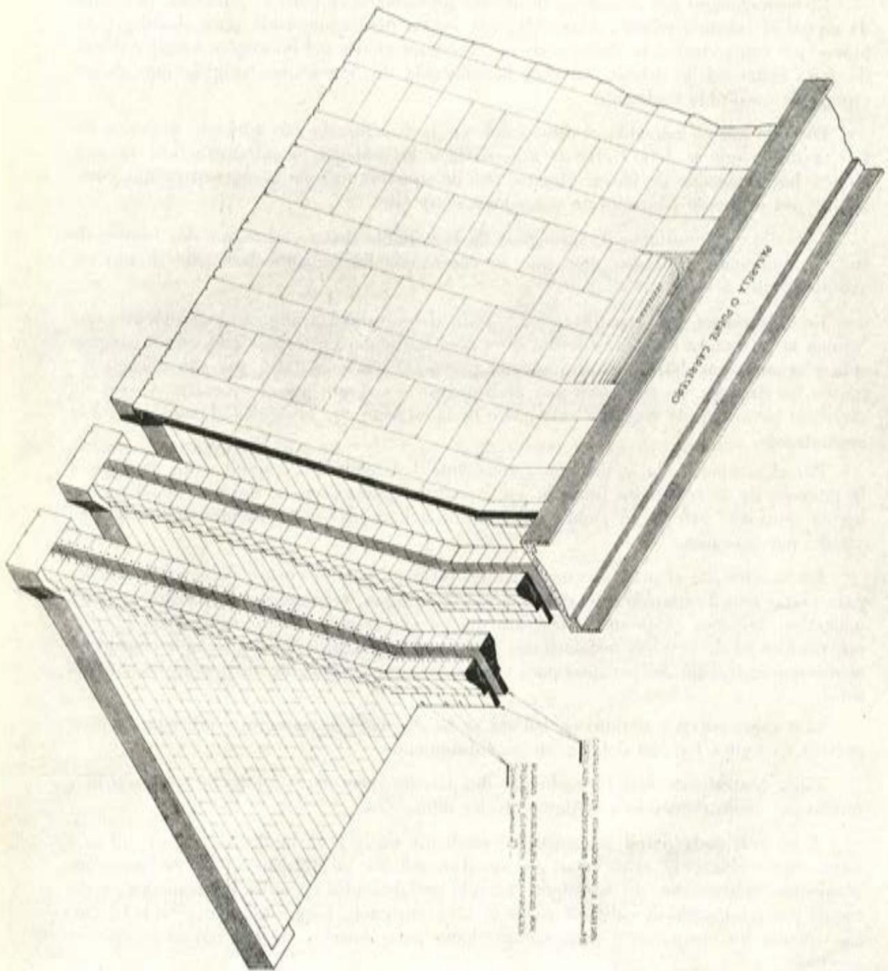
Fig. 1.— Presa de contratueros con superestructura prefabricada. Perspectiva.
