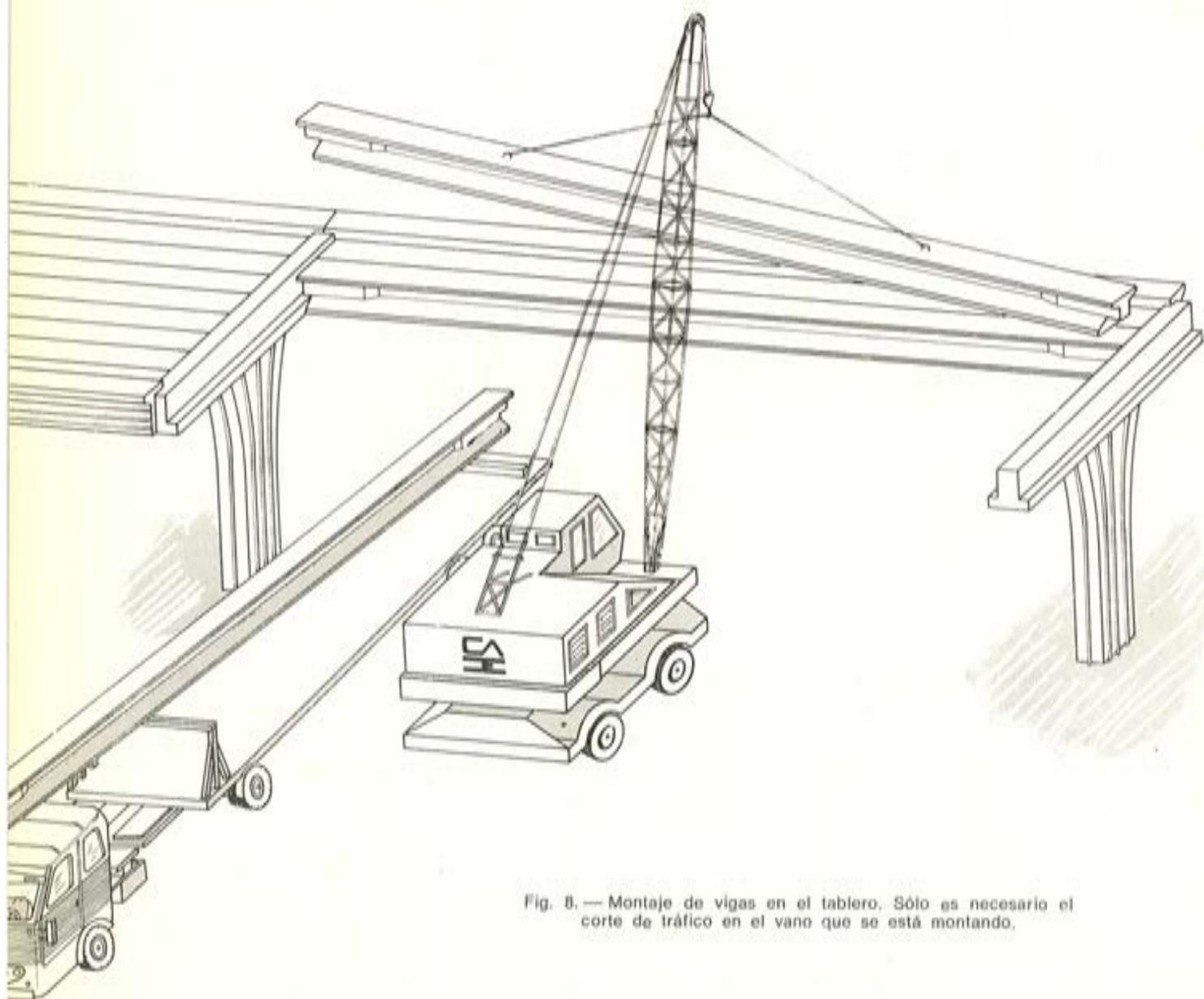
Fig. 8. — Montaje de vigas en el tablero. Sólo es necesario el corte de tráfico en el vano que se está montando.
