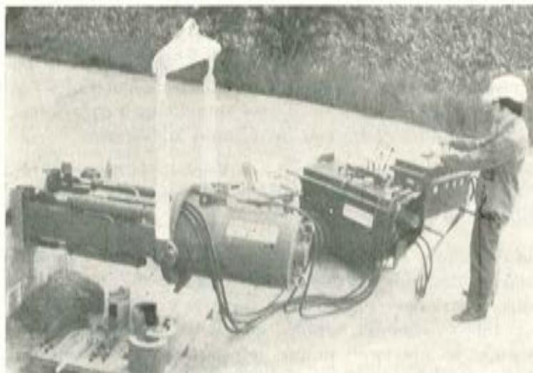
Fig. 6. — Equipo de tesado automático SA500.
