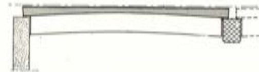
Fig. 4.—Principio fundamental de las placas TT R. Durante la fabricación, la superficie superior de la placa se deja cóncava, con una sagita de magnitud igual a la prevista para la contraflecha vertical de pretensado. Al producirse la transmisión de la fuerza de pretensado al hormigón, la placa se incurva hacia arriba y la superficie superior queda prácticamente plana.
