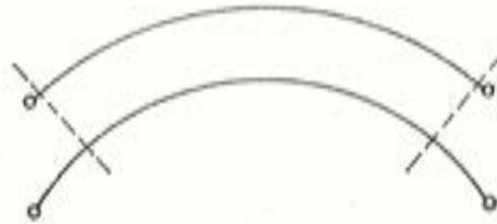
2. En las proximidades de los anclajes, y particularmente en los anclajes ciegos, los alambres exteriores tienen una longitud mayor que los interiores, lo cual se traduce también, si están todos cortados a la misma longitud, en que los alambres exteriores tendrán una tensión mayor que los interiores en su posición definitiva.
