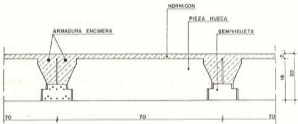
Fig. 1. — Sección del forjado Aedium 18 + 2 con semiviguetas Z-189.
