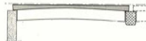
Fig. 4.—Principio fundamental de las placas TT  $\rho$ . Durante la fabricación, la superficie superior de la placa se deja cóncava, con una sagita de magnitud igual a la prevista para la contraflecha vertical de pretensado. Al producirse la transmisión de la fuerza de pretensado al hormigón, la placa se incurva hacia arriba y la superficie superior queda prácticamente plana.
