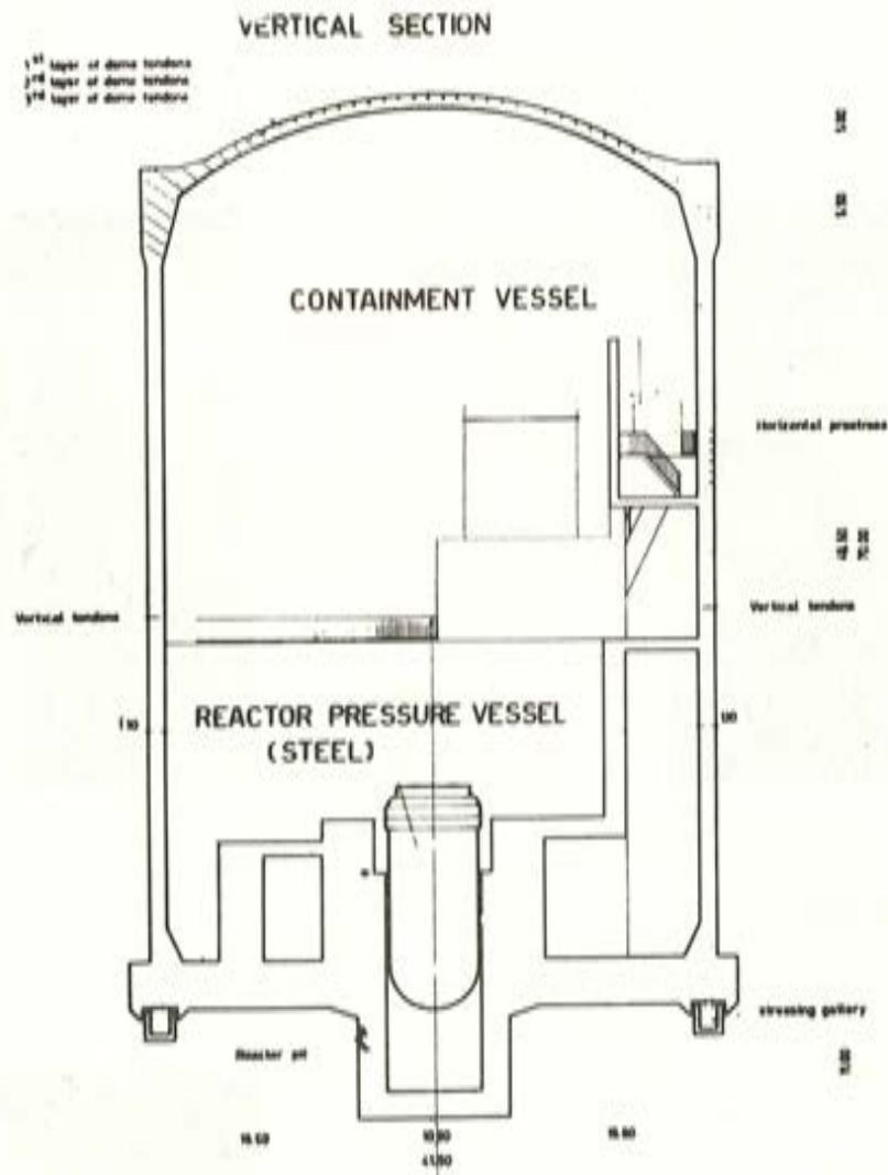
Fig. 12. — Sección de un edificio de contención típico.
