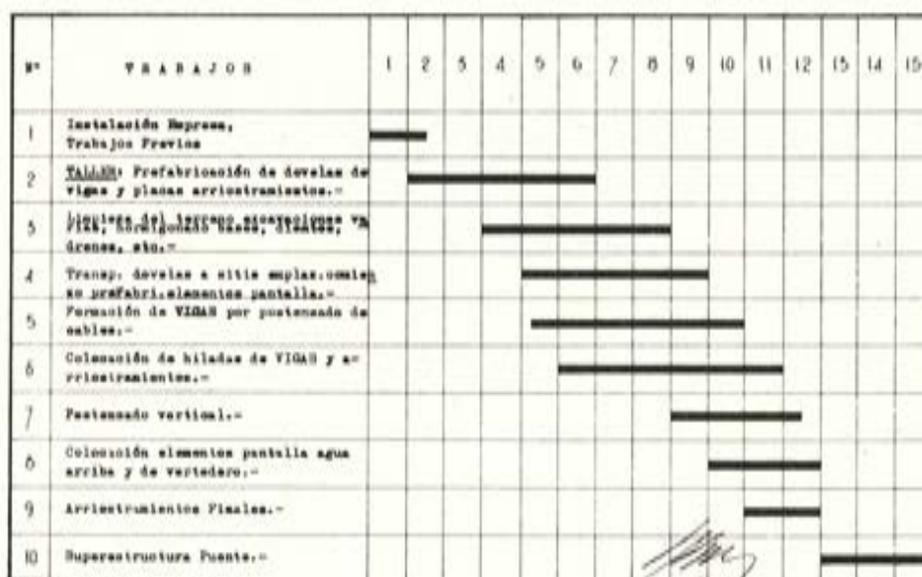
Presa de contrafuertes aligerados. Plan de avance de los trabajos.
