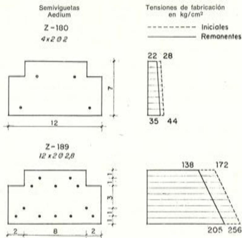
Fig. 3. — Hormigón: Resistencia característica, 400 kg/cm<sup>2</sup>.
