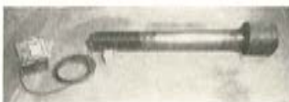
Fig. 7. — Dinamómetro barra de tracción hasta 800 t.
