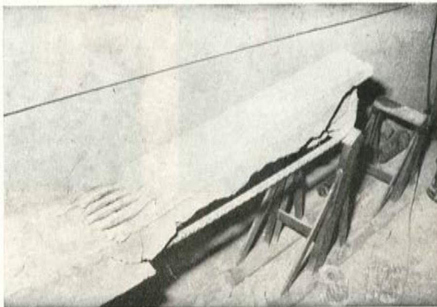
4 elementos, dos del tipo Z-180 y otros dos del Z-189, en los que las dos armaduras de AE 46  $\phi$  20, son de la misma longitud de las viguetas enyesadas y las terminaciones en patilla, empleando estribos de dos ramas de  $\phi$  6 mm de acero AE 24, separados cada 8 cm.
