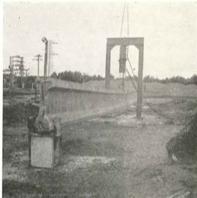
Detalle del proceso de ensayo a rotura de una viga.
