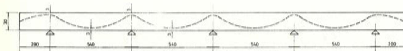
Fig. 3. — Trazado de un tendón longitudinal.
