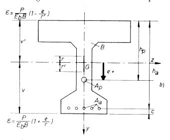
B : SECCION DE HORMIGON, HOMOGENEIZADA I = $I_Z$  . MOMENTO DE INERCIA DE LA SECCION HOMOGENEIZADA
