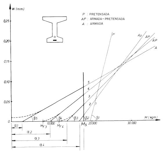
Fig. 11.—Abertura máxima de fisuras en vigas con talón, Resultados experimentales.
