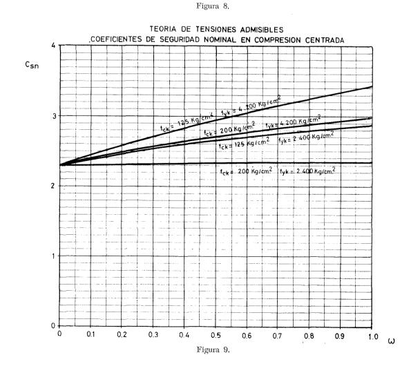
En la figura 9 se ha representado la variación de  $C_{sn}$  en función de  $\omega$  para algunas calidades de hormigón y acero.
