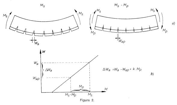
En la pieza de hormigón armado la abertura de fisuras  $W_a$  depende de la armadura adherente  $A_{a1}$ , mientras que en la viga armada y pretensada la abertura  $W_{ap}$  viene regulada, tanto por la armadura adherente  $A_{a1}$  como por el valor del momento  $M_p$ .
