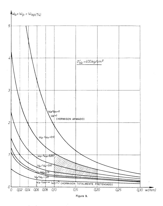
Se puede admitir que las condiciones normales de la clase III corresponden a la zona rayada de la figura 9, comprendida entre las verticales que pasan por las abscisas  $W=0.1 \text{ y } 0.2 \text{ mm y } \text{las curvas } \omega_p/\omega_a=1 \text{ y } 0.1.$
