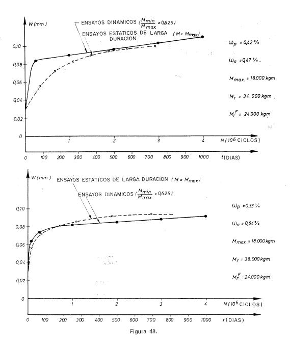
— Por lo que respecta a la fisuración, los ensayos demuestran que las cargas dinámicas aceleran sensiblemente la aparición de las fisuras, aumentando también ligeramente la separación entre las mismas. La influencia de las cargas dinámicas sobre la abertura de fisuras es tanto mayor cuanto menores son la adherencia y las cuantías de las armaduras y mayores los espesores de recubrimiento.
