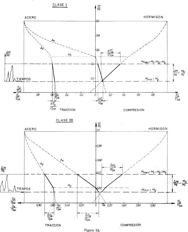
El comportamiento en servicio de una pieza comprobada en clase III depende principalmente del tipo de solicitación, así como de las amplitudes y niveles de las tensiones en los materiales constituyentes. La resistencia a rotura depende, además, de los límites de fatiga de dichos materiales en sus condiciones de utilización, teniendo en cuenta la agresividad del ambiente, los efectos térmicos, los efectos de entalla y de concentración de tensiones, etc.
