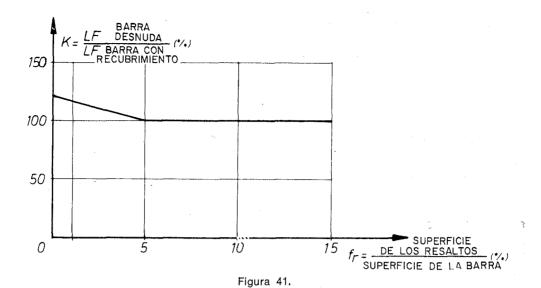
estudiado experimentalmente por M. Stolte. El diagrama de la figura 41 demuestra que, para superficies de resaltos superiores al 5 por 100 de la superficie de la armadura, los límites de fatiga en las armaduras con y sin recubrimiento son iguales. Para armaduras lisas, la reducción de los límites de fatiga originada por el recubrimiento de hormigón puede alcanzar el 20 por 100. En el caso en que el recubrimiento esté constituido por una lechada de inyección, esta reducción es prácticamente nula.
