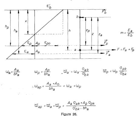
En la figura 26 se da la definición de las diferentes cuantías geométricas y mecánicas de las armaduras, referidas al canto útil  $h_a$ , que caracteriza la posición de la armadura  $A_a$ . El límite elástico del acero  $A_a$ , así como la resistencia del acero  $A_p$  y del hormigón, se toman iguales a los valores característicos  $\sigma_{ak}$ ,  $\sigma_{pk}$  y  $\sigma'_{bk}$ , respectivamente.
