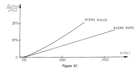
Si los ensayos se efectúan dentro de la gama comprendida entre los 4 y 10 Hz, propugnada por la RILEM, los resultados obtenidos concuerdan, desde el punto de vista de la frecuencia, con las condiciones habituales de las estructuras pretensadas, para las cuales n se mantiene por debajo de los 10 Hz. En los casos especiales en los que n es superior a 10 Hz, los ensayos demuestran que existe un exceso de seguridad.
