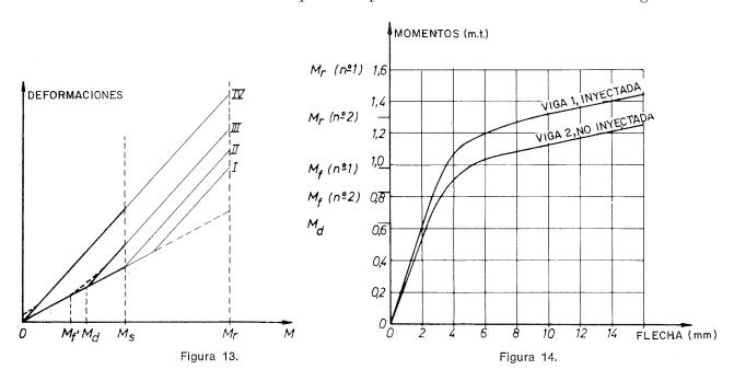
En la clase III, como por otra parte también en las clases I y II, la posición de este punto viene dada por el momento  $M_d$  de descompresión. En efecto, las fisuras que aparecen bajo  $M_s$  no se cierran más que bajo  $M_{f'}$ , de tal forma, que el esquema simple de funcionamiento en los dos regímenes aparece perturbado por una zona curva, de acuerdo que se puede determinar a partir de  $M_{f'}$ , pero que, normalmente, suele despreciarse.
