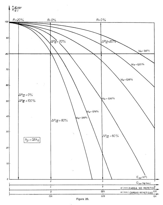
En el caso de cargas no repetidas, la condición límite  $\sigma_a \leq 4 \text{ kg/mm}^2$  corresponde a  $W_{\text{II}} = 0$ . Si se adopta como amplitud  $\Delta P_{i \text{ II}}$  de la clase II, el orden de magnitud del 20 por 100 de  $P_{i \text{ II}, \text{ I}}$  obtenido precedentemente a partir de la condición  $\sigma_b = 30 \text{ kg/cm}^2$ ,
