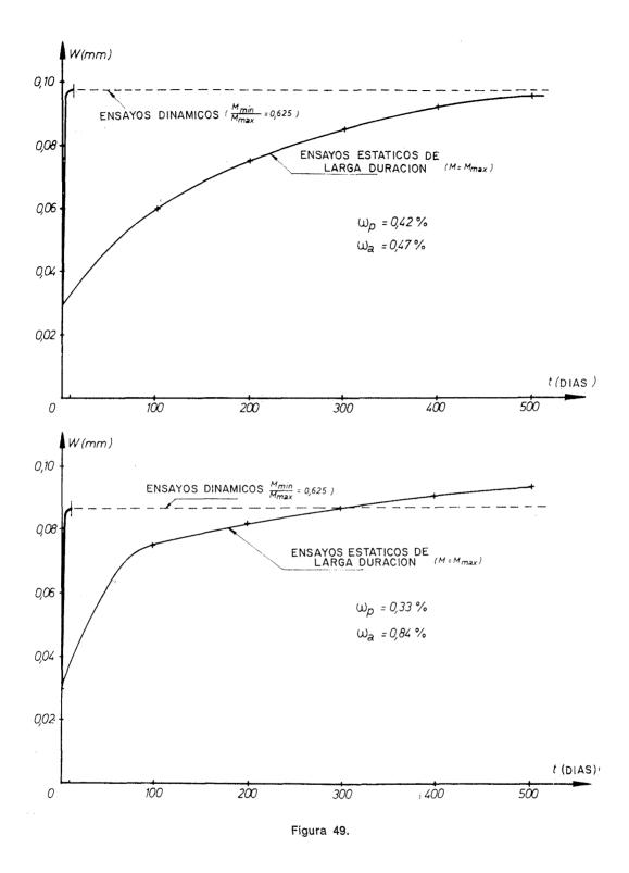
En la figura 48 se comparan, a título de ejemplo, para dos tipos de vigas, la evolución de la abertura de fisuras en función del tiempo, durante ensayos estáticos de larga duración bajo un momento  $M=M_{\rm max}$  y la evolución de abertura de fisuras en función del número N de ciclos, durante ensayos dinámicos bajo momentos comprendidos entre  $M_{\rm min}=0.625~M_{\rm max}$  y  $M_{\rm max}$ , con una frecuencia de 4 Hz.
