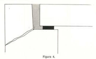
Como la obra se supone ya construida, el colocar ahora una junta resultaría costoso, pues, además, debería fijarse sólidamente al tablero existente con pernos, epoxi o cualquier otro método conocido.
