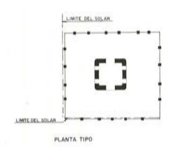
SUPERFICIE PLANTA TIPO 340,00 m² OCUPACION DE ELEMENTOS VERTICALES ESTRUCTURALES EN PLANTA: 13,20 m² = 3,8%
