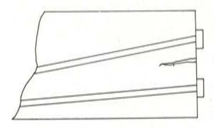
Fig. 3. — Falta de estribo de cabeza.
