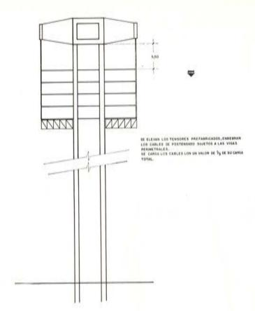
Elevación de los tensores. Descenso de cimbra y construcción de forjados.
