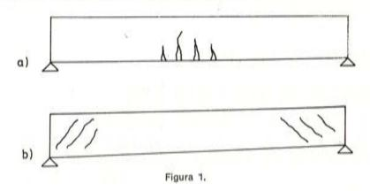
Para reparar esa viga no será suficiente pegar sus fisuras, pues si están producidas por una causa permanente volverán a aparecer.
