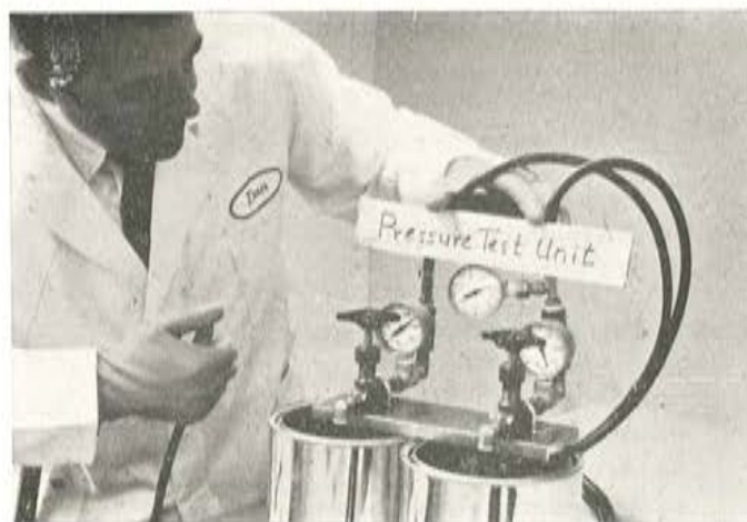
Fig. 8. — Maquinaria utilizada para comprobar la presión de los dos componentes de la resina y que sirve de base para su dosificación.
