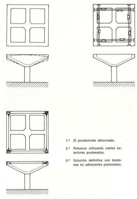
Fig. 29. — Deformación de la cubierta en paraboloide.
