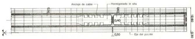
Fig. 16. - Secciones de los dobles voladizos de 92 m de longitud.
