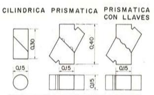
Fig. 3. — Probetas con juntas encoladas inclinadas.
