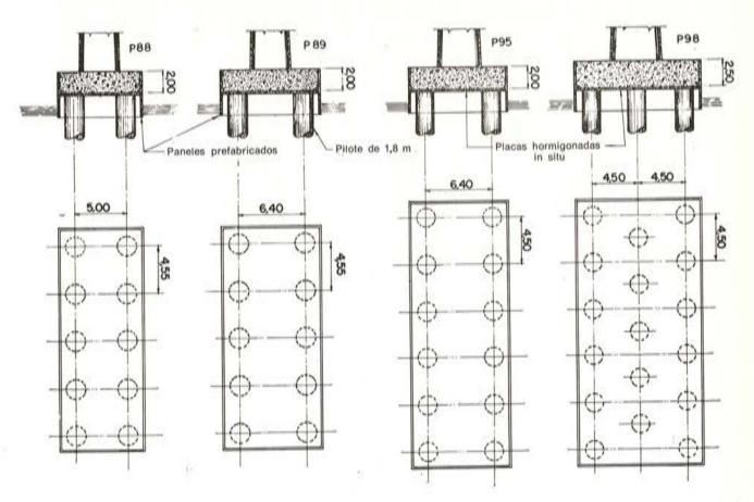
Fig. 20. - Cimentaciones del puente de hormigón.
