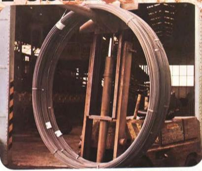
Las estructuras postesas de hormigón con alambre de acero Heva «STABILIZED», proporcionan una mayor seguridad en los climas cálidos y en las aplicaciones específicas para Centrales Nucleares, por su menor relajación, combinada con una mayor resistencia a la tracción a elevadas temperaturas.
