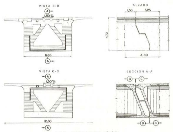
Fig. 5. — Detalles de la junta articulada.
