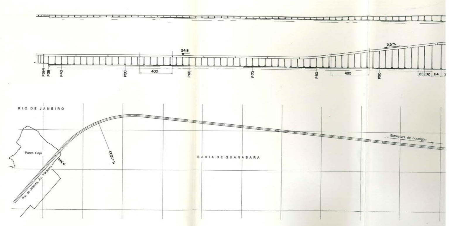
Fig. 1. - Planta general y alzado del puente Río-Nite
