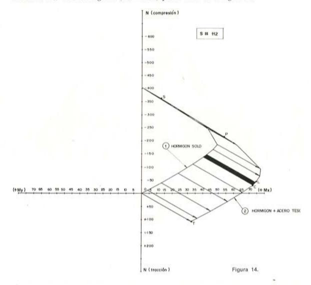
Por último, se ha analizado la sección S # 113, idéntica en hormigón a las 111 y 112, y armada con barras pasivas que se han estimado equivalentes en precio a las de la S # 111. Hemos contado con una relación de costos de acero teso a armadura pasiva de 1,25, y, por ello, hemos sustituido los  $16 \varnothing 0,5$ " de la sección S # 111, por  $16 \varnothing 12,2$  de acero AE-46, que con  $\gamma_s = 1,15$  conduce a f y d = 4.000 kg/cm² (°).
