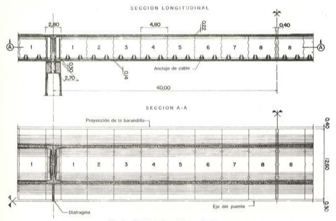
Fig. 4. - Secciones tipo del tramo de 80 m.
