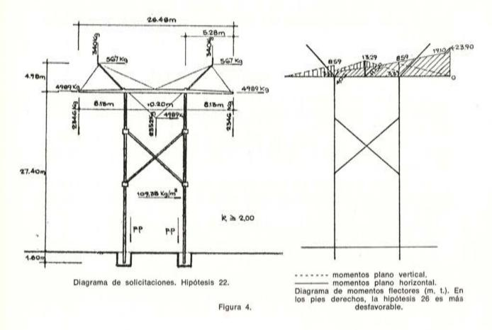
La verificación de secciones se realizó de acuerdo con los métodos del cálculo plástico, con coeficiente de seguridad 2, y a partir de las solicitaciones correspondientes al régimen excepcional indicado en las figuras anteriores.
