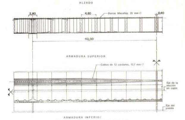
Fig. 6. - Armadura de pretensado de la viga.
