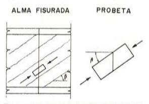
Fig. 2. — Alma fisurada y posición relativa teórica de la probeta,
