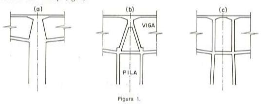
Las uniones tipo celosía han sido, hasta ahora, las más corrientemente utilizadas para los enlaces entre vigas y pilas en los puentes de gran luz del Japón. Antes de proceder a la construcción, en 1964, del puente Amakusa, se realizaron ensayos de carga sobre un mo-
