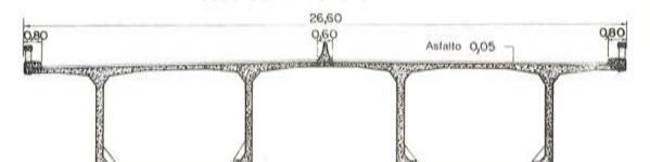
SECCION TRANSVERSAL DEL PUENTE
