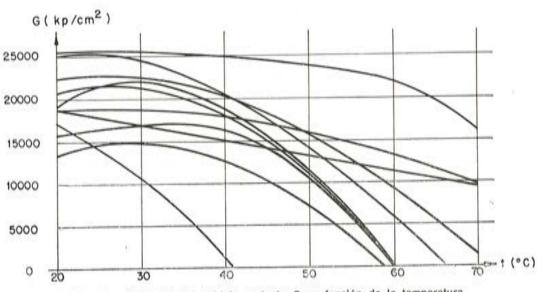
Fig. 4. — Variación del módulo cortante G en función de la temperatura.
