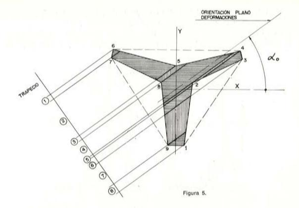
Para determinar los valores de las bases, se ha establecido en el programa una función "ancho de fibra", cuyo argumento es la distancia (D) de dicha fibra al origen de coordenadas. Esta función, llamada F N B (D) en el programa, obtiene los pares de puntos de corte de cada circuito, necesariamente convexo para ello, con la fibra, y por acumulación, con el signo correspondiente, determina el ancho de fibra (B), y las coordenadas  $(U_0, V_0)$  de su centro de gravedad.
