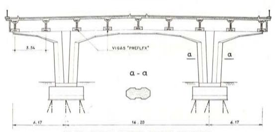
Fig. 39. — Viaducto de Wilrijk. Secciones transversales.
