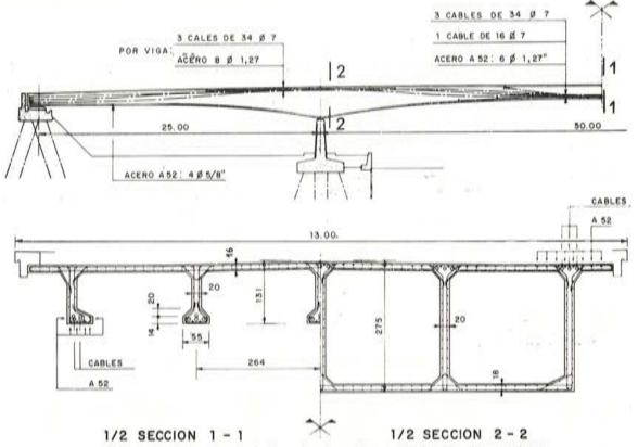
Fig. 25. — Puente de Gervoort. Trazado de cables y distribución de armaduras.
