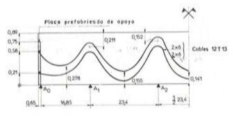
Fig. 9. — Alzado esquemático de la disposición de los cables en Herbitzheim. La escala en alzado es veinte veces mayor.
