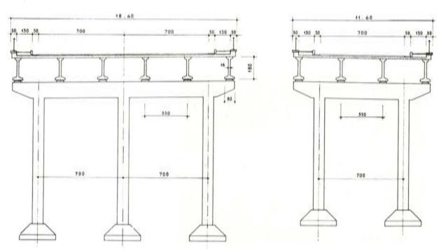
Fig. 49. - Viaducto S2. Secciones transversales.
