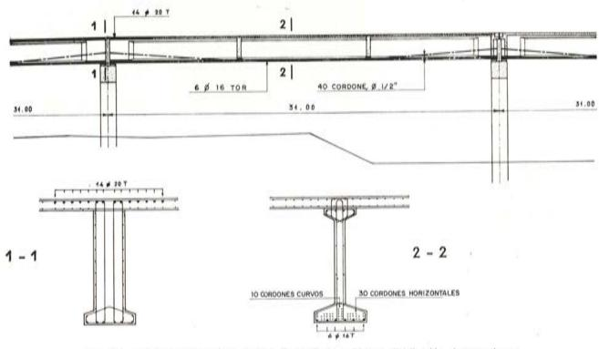
Fig. 50. — Viaducto S2. Tramo normal. Trazado de cables y distribución de armaduras.
