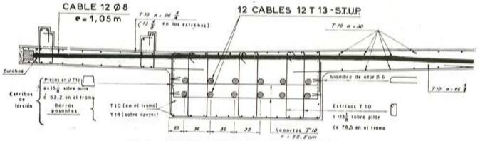
Fig. 2. - Armaduras y cables del puente de Herbitzheim,
