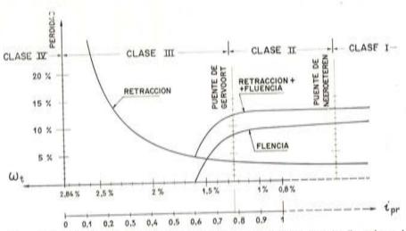
Fig. 29. — Variación de las pérdidas de pretensado ocasionadas por la fluencia y la retracción, en función de  $\omega_t$ .
