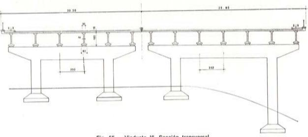
Fig. 55. - Viaducto 16. Sección transversal.
