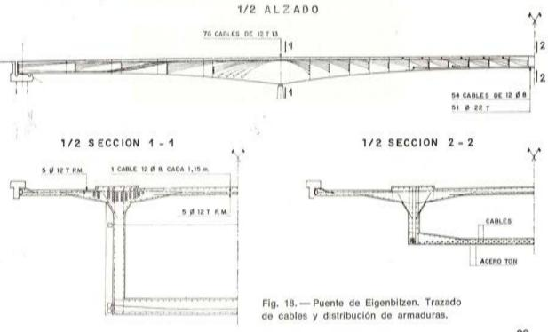
La Iosa superior se pretensó transversalmente mediante tres cables de  $12 \oslash 8$  por dovela; es decir, dispuestos a 1,17 m entre ejes. Este pretensado parcial se completó con una armadura superior pasiva, de  $5 \oslash 12$  Tor por metro, encima de las vigas y otra inferior de  $5 \oslash 12$  Tor en el eje del puente.
