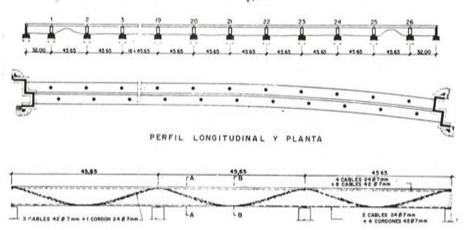
DISPOSICION DE LOS CABLES EN LA SECCION LONGITUDINAL
