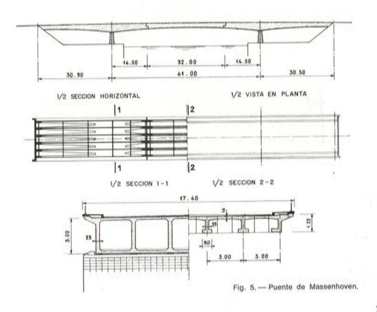
La tercera estructura de esta serie es un puente de tres tramos construido en voladizo. Se trata del puente de Massenhoven, situado sobre el canal Albert (figs. 5 a 7).
