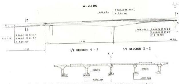
Fig. 14. — Puente de Mol-Gompel. Trazado de cables y distribución de armaduras,
