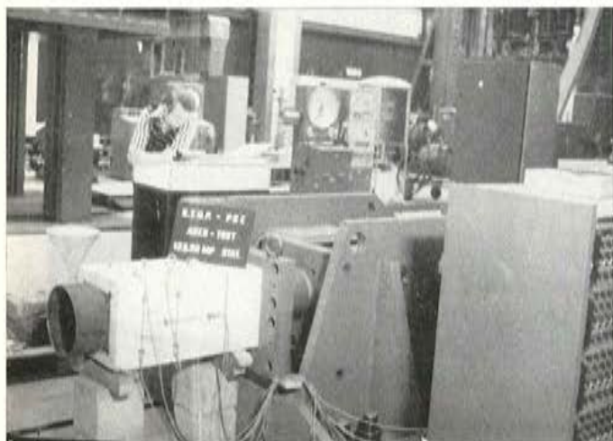
Foto 29. Bloque de hormigón reducido en el anclaje pasivo, durante el ensayo.
