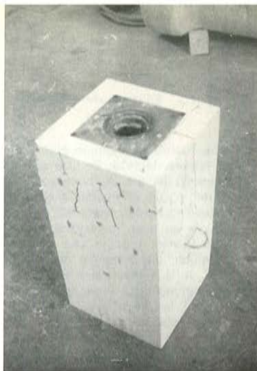
Foto 31. El bloque de hormigón después del ensayo.
