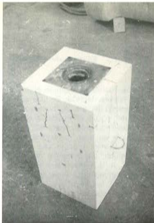
Foto 31. El bloque de hormigón después del ensayo.
