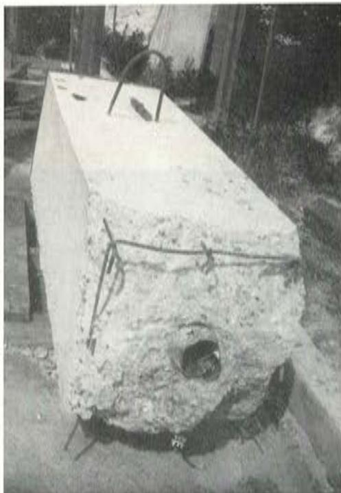
Foto 34. Hormigón descubierto alrededor de las uniones entre vainas. No se mostraron fugas.
