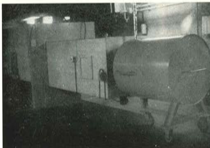
Foto 25. Dispositivo de aislamiento durante el ensayo del anclaje a baja temperatura ( -23^{\circ}\text{C} )
