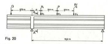
La distancia "a" entre el apoyo de continuidad y el punto de aplicación de la primera carga, se tomó, sucesivamente, igual a: 0,61 m; 0,91 m; 1,22 m; 1,98 m y 2,74 metros.
