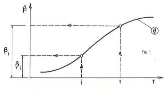
Si t es el instante en que se quiere evaluar el fenómeno de la fluencia y j el instante de la puesta en carga, entonces  $\beta_t$  y  $\beta_j$  se deducen de la manera indicada en la figura 1.
