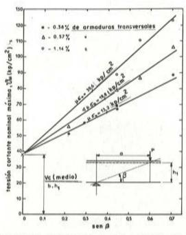
Fig. 23.—Variación del valor máximo de la tensión cortante, en función del ángulo de inclinación
