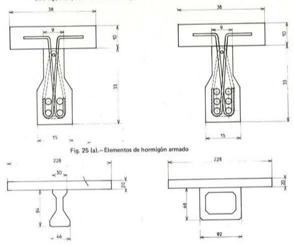
Fig. 25 (b).-Elementos de hormigón pretensado
