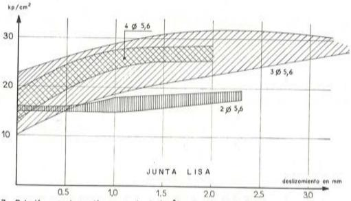
Fig. 17.—Relación entre la tensión rasante (en kp/cm²) y el valor del deslizamiento (en mm). Caso de super-
