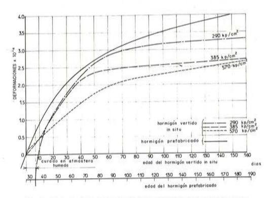
Fig. 31.-Variación de las deformaciones de los hormigones, en función del tiempo
