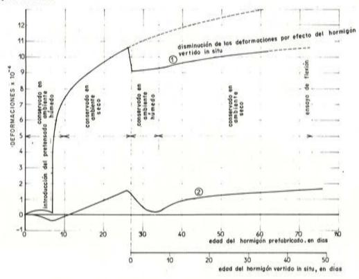
Fig. 32.-Variación de las deformaciones en el hormigón prefabricado, én función del tiempo
