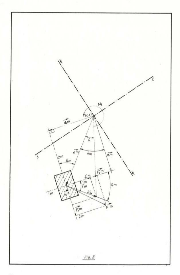
expresiones que nos dan las fuerzas generadas, según las direcciones principales, en el extremo superior de "m". Estas fuerzas reactivas, se crean simultáneamente como respuesta individual de "m" al momento torsor M<sub>t</sub>, producido por la rotación del conjunto estructural alrededor de su centro de rigidez. El momento de éstas fuerzas respecto a dicho centro será, evidentemente:
