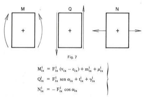
siendo (m, t) esfuerzos por peso propio y  $(\mu, \gamma)$  esfuerzos por carro de avance.
