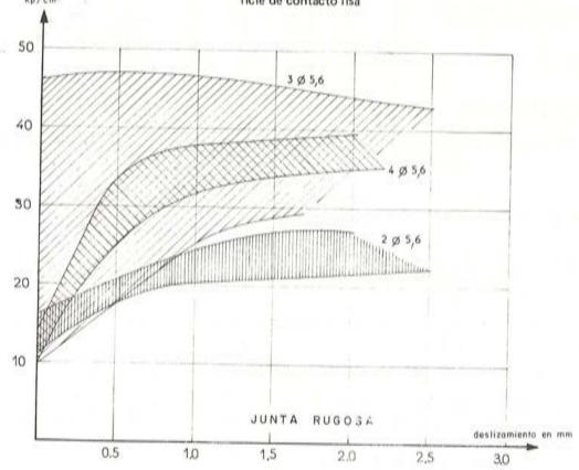
Fig. 18,—Relación entre la tensión rasante (en kp/cm²) y el valor del deslizamiento (en mm). Caso de super-Conclusiones
