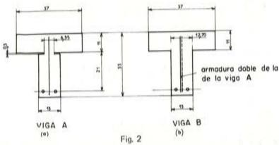
Con el fin de conservar la misma cuantía de armadura transversal en los dos tipos de piezas, las armaduras verticales de las del tipo B eran el doble de las dispuestas en los elementos del tipo A, según puede apreciarse en la figura.
