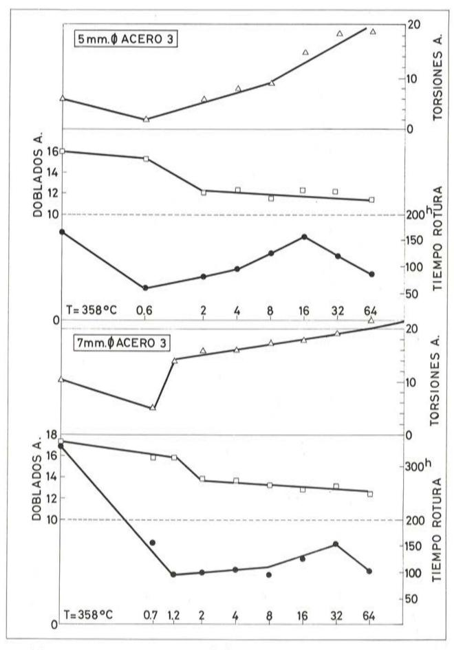
caso, por encima de 10, mientras que los tiempos de rotura son siempre inferiores a 200 horas, poniendo de manifiesto la inconsistencia de un criterio que se basara únicamente en el número de doblados para inferir el comportamiento frente a la corrosión.
