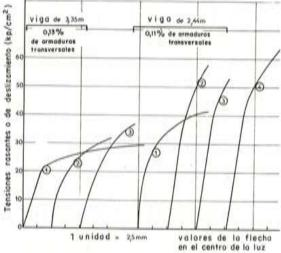
Fig. 11.—Influençia de la rugosidad en el valor del deslizamiento
