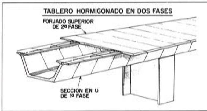
FIG. 14. Esquema de tablero ejecutado en dos etapas.
