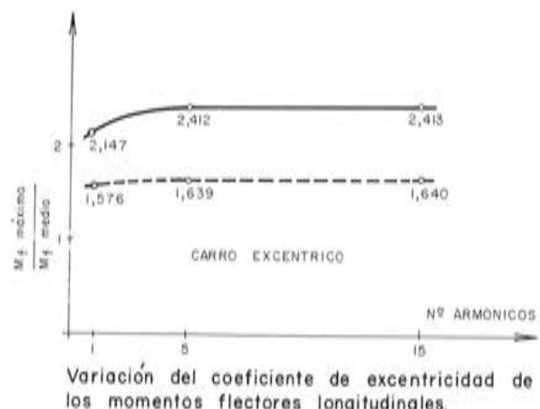
Variación del coeficiente de excentricidad de los momentos flectores longitudinales.
