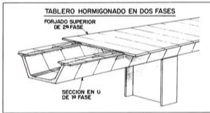
FIG. 14. Esquema de tablero ejecutado en dos etapas.
