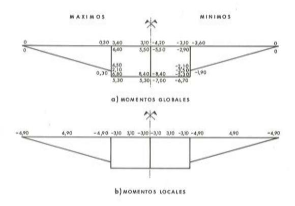
Figura 14.- LAMINA PLEGADA. RESULTADOS. MOMENTOS FLECTORES TRANSVERSALES (LUZ \* 25,00 m)
