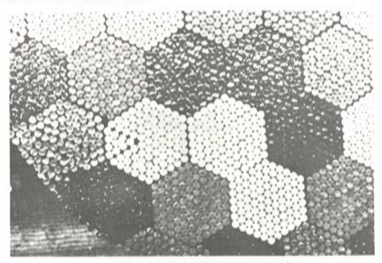
Fig. 4.—Torón de alambres paralelos compactados.
