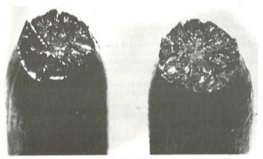
Figura 3 - Izquierda, rotura a temperatura ambiente. Derecha, rotura a - 165ºC.
