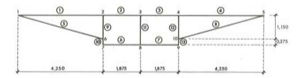
Figurall -- LAMINA PLEGADA, SECCION TRANSVERSAL
