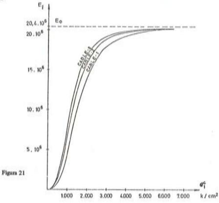
El cable 1 tiene mayor proyección horizontal que el cable 2, y éste mayor que el 3, a igualdad de alturas. Se observa que para una misma tensión  $\sigma$ , el módulo de elasticidad ficticio disminuye al aumentar la proyección horizontal.
