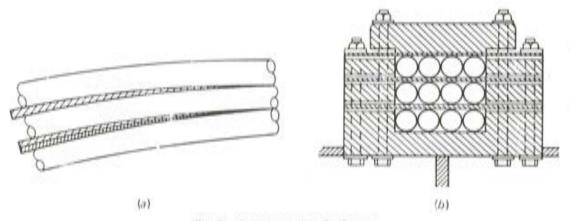
Fig. 9.-Anclaje en silla, St. Severin.
