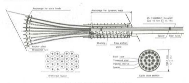
Fig. 3.-Anclajes del Puente de Hoesch.
