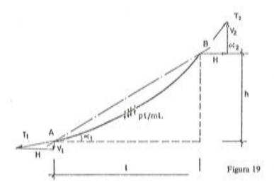
Al dar un  $\Delta T_1$ , (suponiendo A y B fijos) se produce  $\Delta L^T$  que se compone de dos sumandos:  $\Delta L_C$  debido a la variación de la catenaria y  $\Delta L_e$ , elástico.
