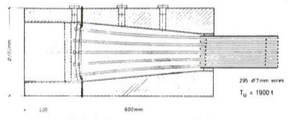
Fig. 14.-Anclaje para alambres paralelos tipo "Hi-Am".
