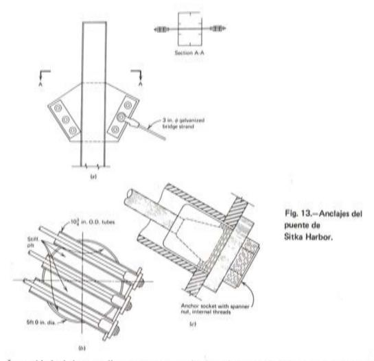
La cavidad cónica se rellena con una mezcla de resina epoxi y bolas de acero de modo que, una vez endurecida, asegura la transmisión gradual por rozamiento entre los alambres y la pared del cono.
