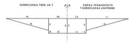
Figura 15. - LAMINA PLEGADA. RESULTADOS. AXILES TRANSVERSALES (+ m-1)
