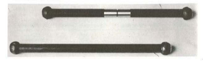
Figura 6 — Probetas con cabezas recalcadas para ensayos a bajas temperaturas.
