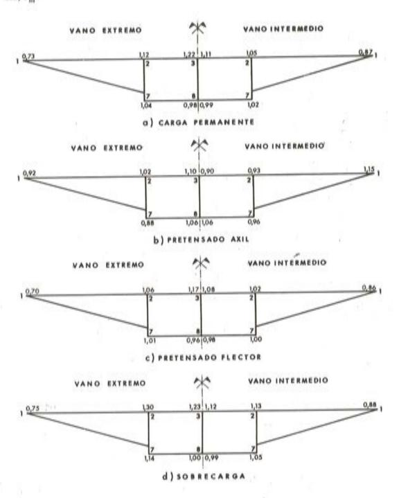
Figura 10 - k<sub>1</sub> COEFICIENTES DE EXCENTRICIDAD DE FLEXION LONGITUDINAL
