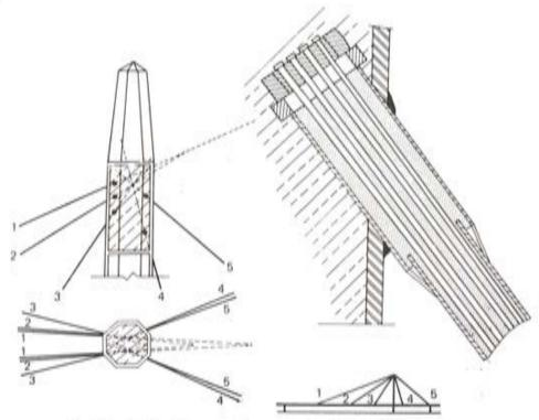
Fig. 16.-Anclaje de pretensado convencional. Pasarela Schiller-Strasse.
