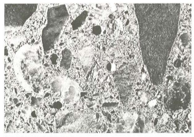
Fotomicrografía de un testigo de hormigón.
