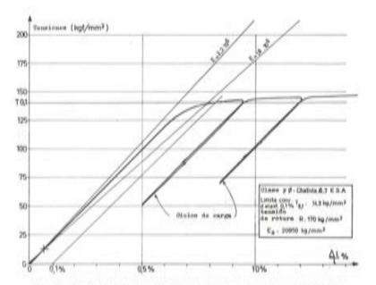
Fig. 6.-Diagrama de tracción de un alambre de pretensado de φ 7.
