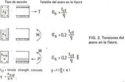
El esfuerzo de pretensado da lugar a un descenso del eje neutro y de este modo se limita la tensión de tracción media en la cara fisurada a valores no muy por encima de la tensión de rotura a tracción del hormigón  $e_{\rm t}=0.15$  a 0,35 por 100, correspondiendo al acero tensiones de 30 a 70 N/mm², que están muy por debajo de las tensiones para el acero que se utiliza en las estructuras de hormigón armado no pretensadas, que normalmente son de 4 a 10 veces más altas.
