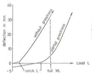
FIG. 6. Comparación de las flechas entre vigas doble T con la misma A<sub>BI</sub> + A<sub>D</sub> (según los ensayos de Stuttgart).
