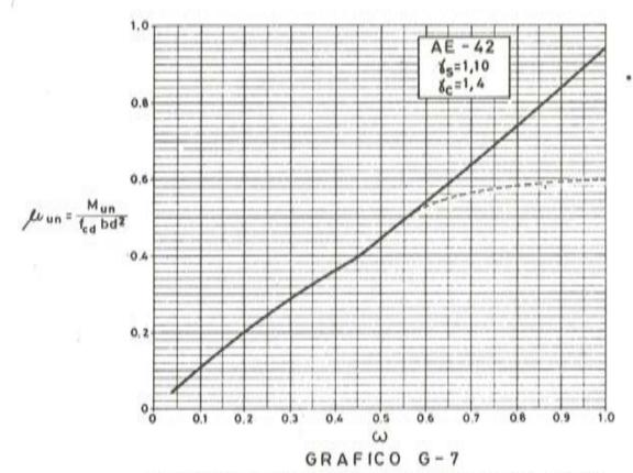
HORMIGON ARMADO, CON ARMADURA DE COMPRESION PARA CUANTIAS SUPERIORES A LA CRITICA.
