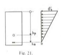
La sección A se hace infinita cuando (fig. 21) se llega a  $\overline{\sigma}_b^*$  en la fibra superior y a una tensión nula al nivel de la armadura pasiva:  $\sigma_a = 0$ , y cuando, sin embargo, el equilibrio de los esfuerzos normales exige en esta armadura un esfuerzo de tracción (A  $\sigma_a$ ).
