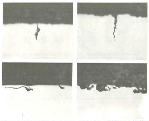
Fotos 1 a 4: Detalle de la sección transversal de los aceros de la serie 2. Longitud de fisuras entre 30 y 90 µm.
