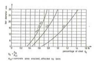
FIG. 5. Abaco en el que se establecen relaciones entre el diámetro del redondo, el porcentaje de armadura y el ancho de fisura media V<sub>m</sub>, debida a una tracción axil.
