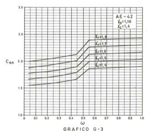
HORMIGON ARMADO, CON CUANTIAS DE ARMADURA DE TRACCION SU-PERIORES A LA CRITICA, SIN EMPLEAR ARMADURA DE COMPRESION.
