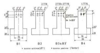
Fig. 3.-Secciones transversales de las viguetas B.
