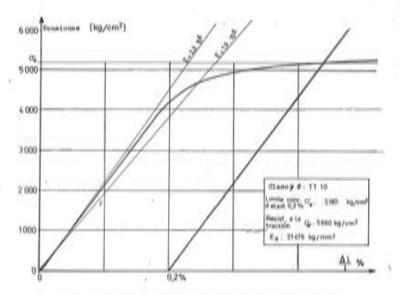
Fig. 9.-Diagrama de tracción de una barra Tentor φ 10.
