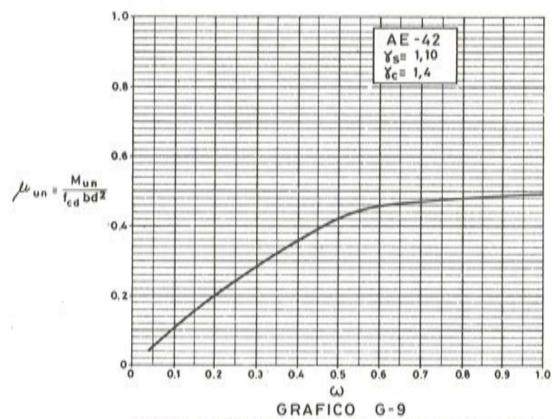
HORMIGON ARMADO, CON CUANTIAS DE ARMADURA DE TRACCION SU-PERIORES A LA CRITICA, SIN EMPLEAR ARMADURA DE COMPRESION.
