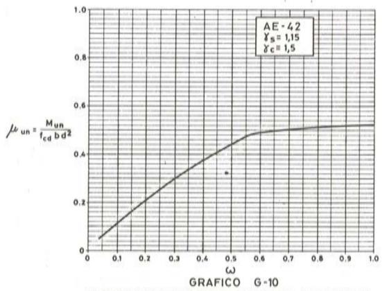
HORMIGON ARMADO, CON CUANTIAS DE ARMADURA DE TRACCION SU-PERIORES A LA CRITICA, SIN EMPLEAR ARMADURA DE COMPRESION.
