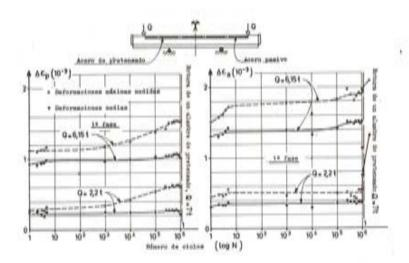
Fig. 17.—Variaciones de las deformaciones relativas de las armaduras en función del número de cargas aplica das en la primera fase (vigueta B3')
