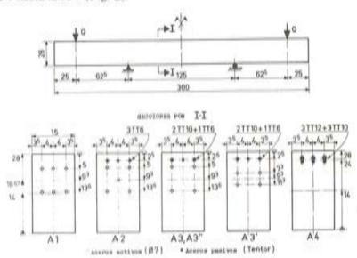
Fig. 2.-Sección transversal de las viguetas A
