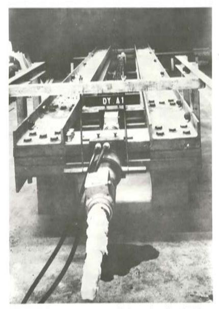
Fig. 8.-Banco para poner en tracción las armaduras de pretensado.
