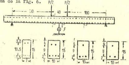
Los ensayos dinámicos se realizaron según los esquemas
