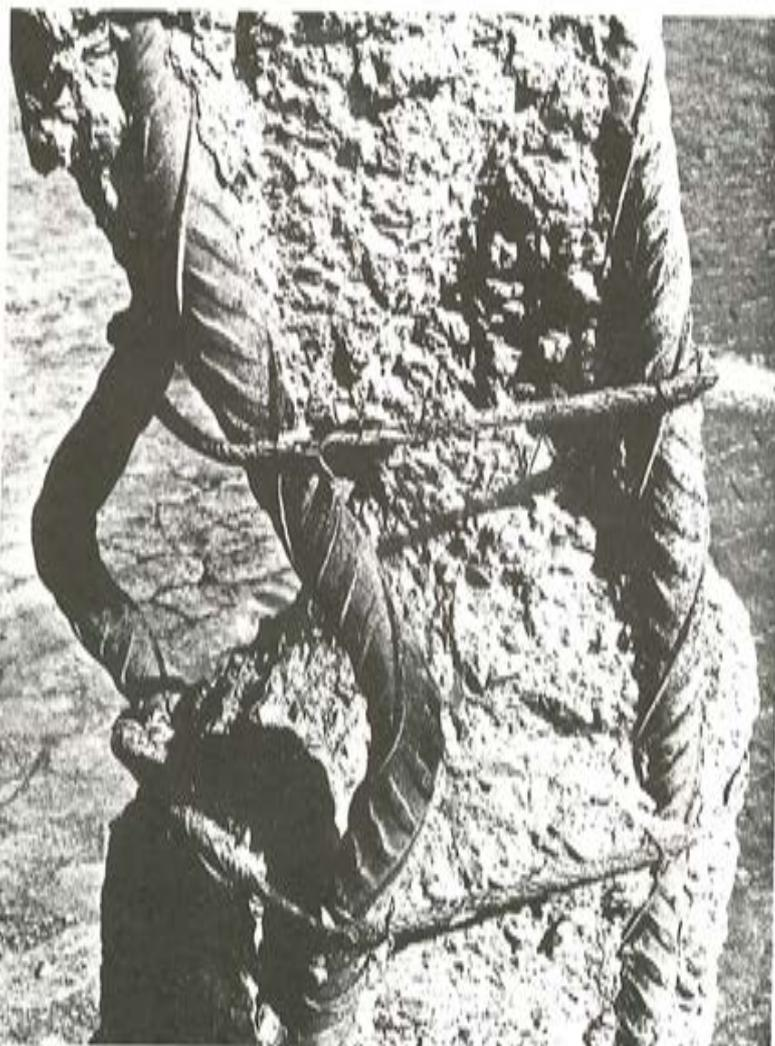
Ensayo de pilares a compresión centrada.
