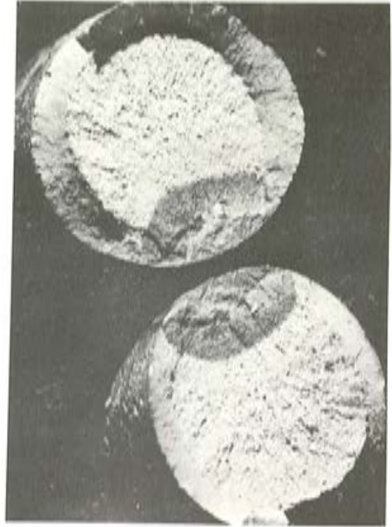
Fig. 5. Lúnula de corrosión fisurante bajo tensión producida en servicio.
