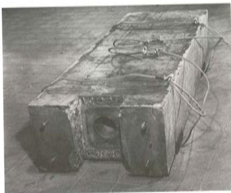
Fig. 2.— Probeta de hormigón armado. Una vez pretensada se ensaya a  $-165^{\circ}\text{C}$ .
