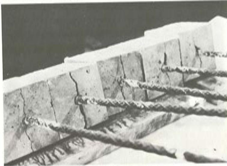
Fig. 3 Rotura de "splitting" del hormigón.
