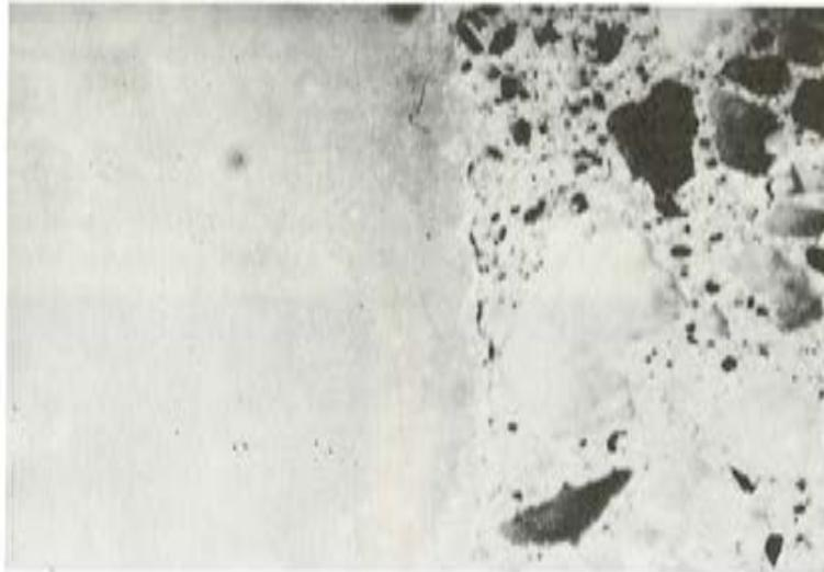
Fig. 1. Fisuras del mortero.
