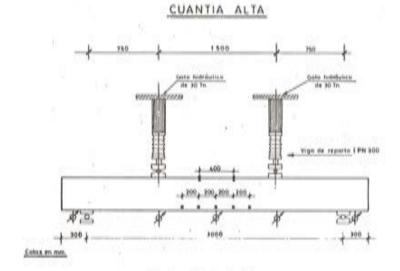
Fig. 2.- Montaje del ensayo.
