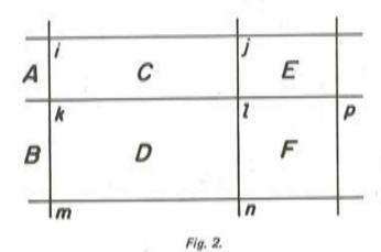
22. Hasta aquí se ha tratado del esfuerzo cortante Q a lo largo de k l, lo que no es suficiente. Es necesario, además, que el valor de Q en l sea el mismo en k l que en la frontera lp (fig. 2) que está en prolongación de k l, entre los elementos E y F. Sea  $Q_l^{CD}$  el valor de  $Q_{kl}^{CD}$  en l, es decir el valor de Q en l tanto en C como en D. Debe cumplirse en l la condición:
