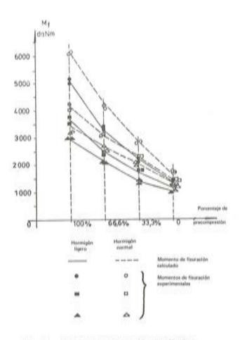
Fig. 11.- Momentos de fisuración de cálculo y experimentales,
