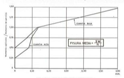
Fig. 6.- Evolución de la fisuración.
