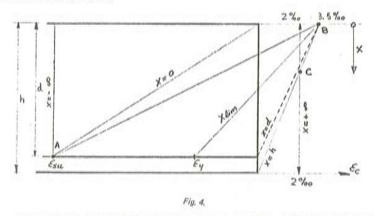
Para el cálculo de la resultante de tensiones en el hormigón, se divide la zona de compresión en 10 fajas de igual altura. La tensión media del hormigón en la faja se considera que corresponde a una fibra situada al 60 por 100 de profundidad en dicha faja, y se sitúa la resultante de dicha faja en el centro de la misma.
