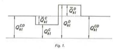
otra carga igual pero hacia abajo. Esta otra carga puede descomponerse en otras dos,  $\overline{Q}_{kI}^C$  y  $\overline{Q}_{kI}^D$ , aplicadas a lo largo de kI en C y D, de modo que
