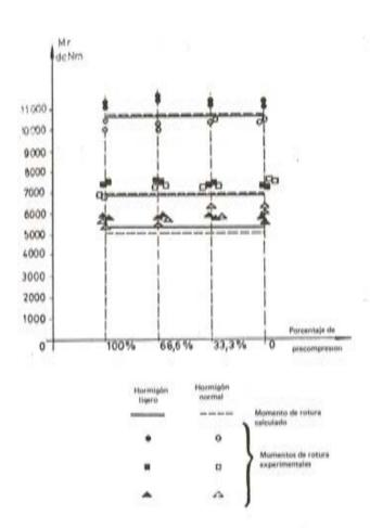
Fig. 10,— Momentos de rotura de cálculo y experimentales,
