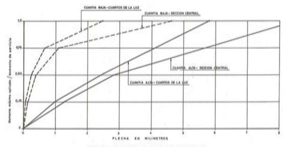
Fig. 3.— Evolución de las flechas durante el ensayo (Valores medios),
