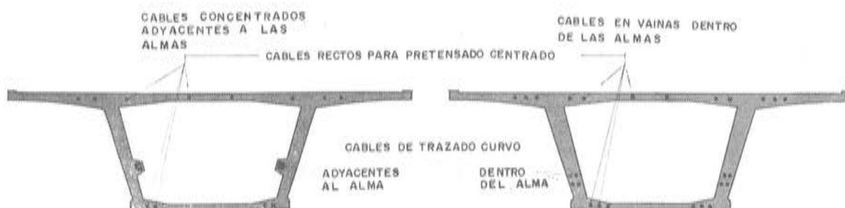
Fig. 28. Cables en el exterior y en el interior de las almas.
