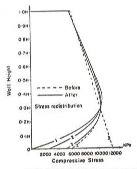
Fig. 13. Efectos de la fluencia sobre el pretensado circunferencial.
