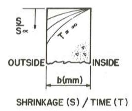
Fig. 4. Distribución de la retracción en el muro al secarse por una de sus superficies.
