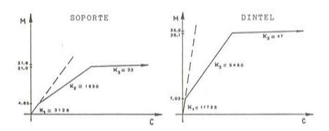
Fig. 7. Diagramas Momento-Curvatura de las distintas secciones.
