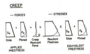
Fig. 10. Diagramas de esfuerzos y deformaciones respecto al pretensado circunferencial después de los efectos de la fluencia.
