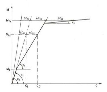
Fig. 3. Incrementos de curvatura de cada fase
