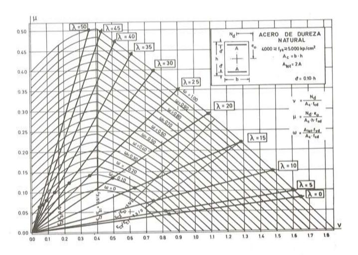
Fig. 3. Pandeo de soportes rectangulares según EH-73. Diferentes rectas de dimensionamiento, para cada esbeltez  $\lambda$ , fijados  $e_0/h=0.05$ , AE-42N,  $\gamma_8=1.10$ .
