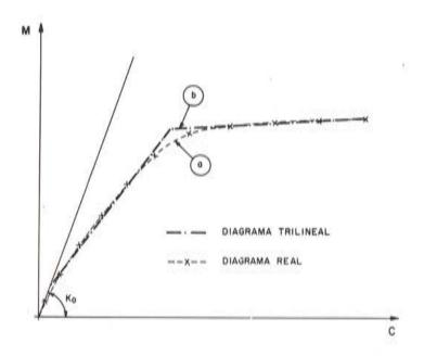
Fig. 1. Diagrama momento-curvatura (M-C) de una sección genérica.
