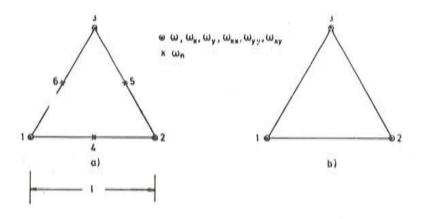
Fig. 1. Hiperelementos con aproximación polinómica de 5º grado.
