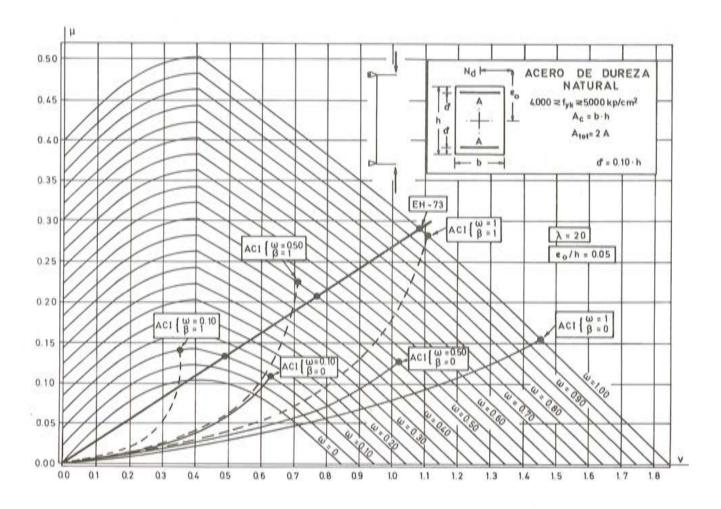
Fig. 8. Curvas de dimensionamiento con el código ACI-71, para diferentes cuantias  $\omega$  de acero y distintos valores del coeficiente  $\beta$  fijadas la esbelted  $\lambda$  del soporte y la excentricidad  $e_0/h$ .
