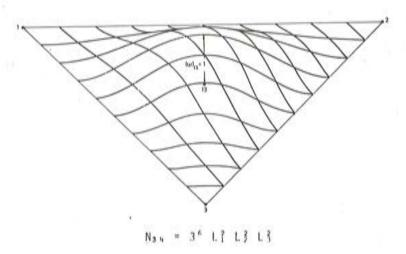
Fig. 17. Función de forma asociada al grado de libertad  $U_{3.4}$  $\equiv$  ( $\omega$ )  $_{1.3}$
