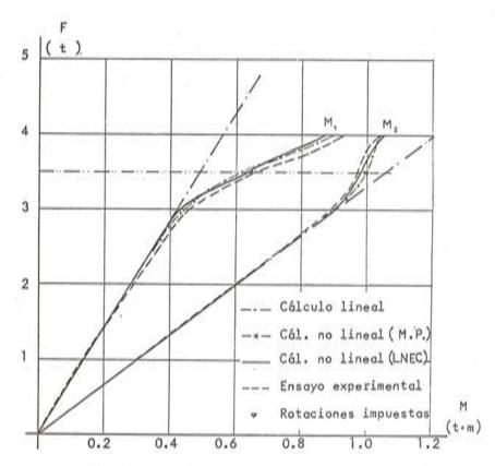
Fig. 5. Diagrama F-M según los distintos métodos utilizados.
