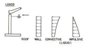
Fig. 2. Fuerzas horizontales debidas a las acciones sísmicas.
