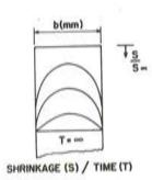
Fig. 7. Distribución de la retracción en un muro que se seca por sus dos paramentos.
