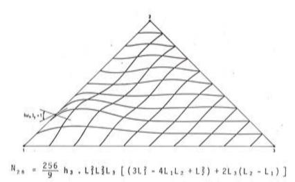
Fig. 16. Función de forma asociada al grado de libertad  $U_{28}$   $\equiv$  ( $\omega_{\rm n}$ )  $_7$
