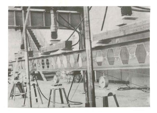
Ensayo a flexión de una viga metálica.
