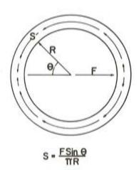
Fig. 3. Distribución del esfuerzo cortante.
