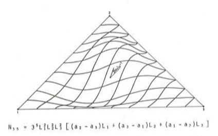
Fig. 18. Función de forma asociada al grado de libertad  $U_{3.5} =$  ( $\omega_{\rm x}$ )  $_{1.3}$
