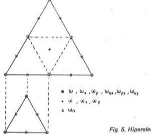
Fig. 5. Hiperelemento compuesto.
