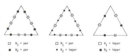
Fig. 6. Disposición de los nudos en un lado.
