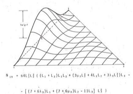
Fig. 14. Función de forma asociada al grado de libertad  $U_{19} \equiv (\omega)_4$
