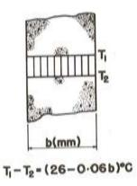
Fig. 8. Retracción global, expresada en el equivalente de distribución de temperaturas.
