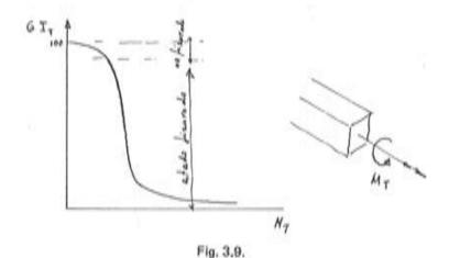
Los ensayos realizados en vigas de hormigón armado solicitadas a torsión, demuestran que su rigidez, GI<sub>T</sub>, se reduce muy rápidamente a partir de la fisuración del hormigón. En vigas de hormigón pretensado, se prolonga algo más la respuesta proporcional; pero también cae rápidamente y, demás, esta caída es mucho más rápida que la de flexión. (Figura 3.9).
