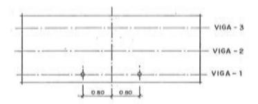
Fig. 3.11 Situación de las cargas para rotura.
