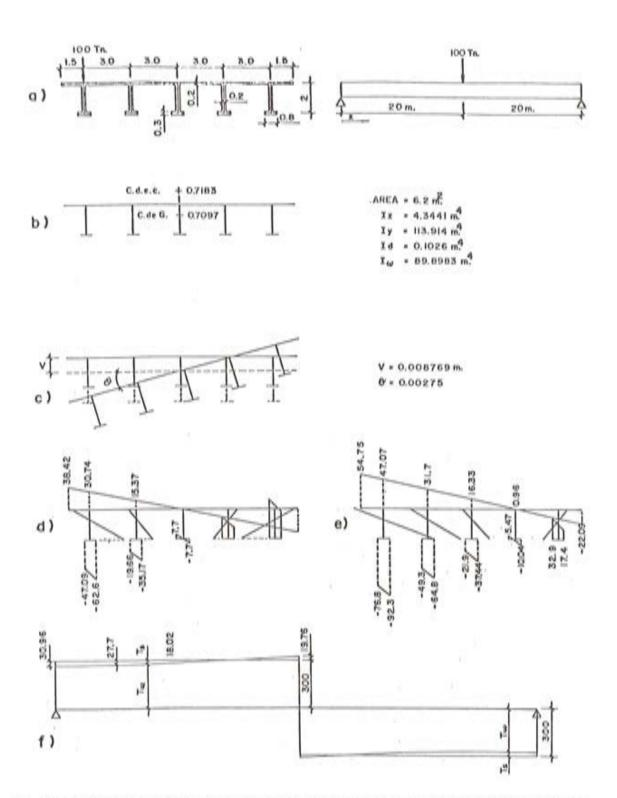
Fig. 1.2. Alabeo torsional. a) Sección transversal; b) Características mecánicas; c) Corrimientos debidos a la flexión (v) y a la torsión ( $\theta$ ); d) Tensiones,  $\sigma_\chi$ , debidas al alabeo torsional; e) Tensiones  $\sigma_\chi$ , debidas a la flexión y al alabeo torsional; f) Distribución, a lo largo de la luz, del momento torsor, resistido por alabeo torsional ( $T_w$ ) y por tensiones tangenciales de St. Venant ( $T_s$ ).
