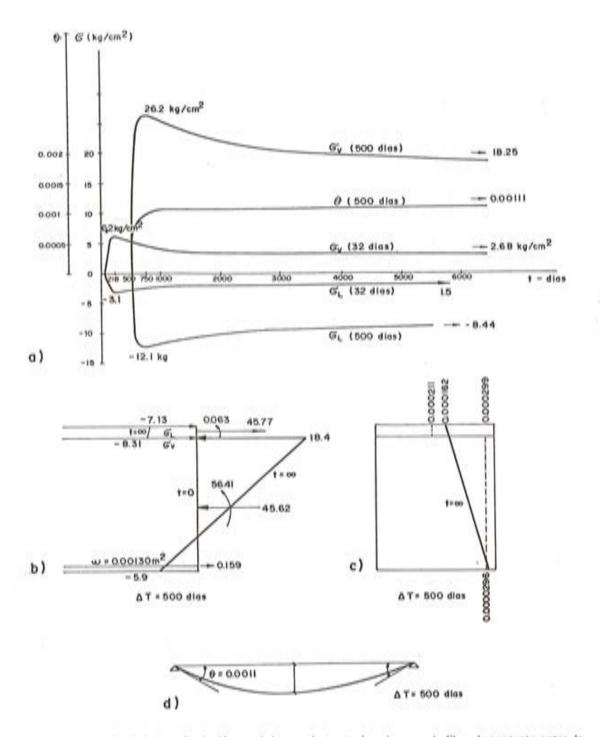
Fig. 3.2. Retracción de la losa. Evolución en el tiempo de  $\sigma_{\rm v}$ ,  $\sigma_{\rm I}$  (tensiones en la fibra de contacto entre la viga y la losa), y  $\theta$ , (giro de la viga en el apoyo); b) tensiones, para t =  $\infty$ , en el centro de la luz; c) Deformaciones en la sección central de la luz; d) Giros y corrimientos de la viga, para t =  $\infty$ .
