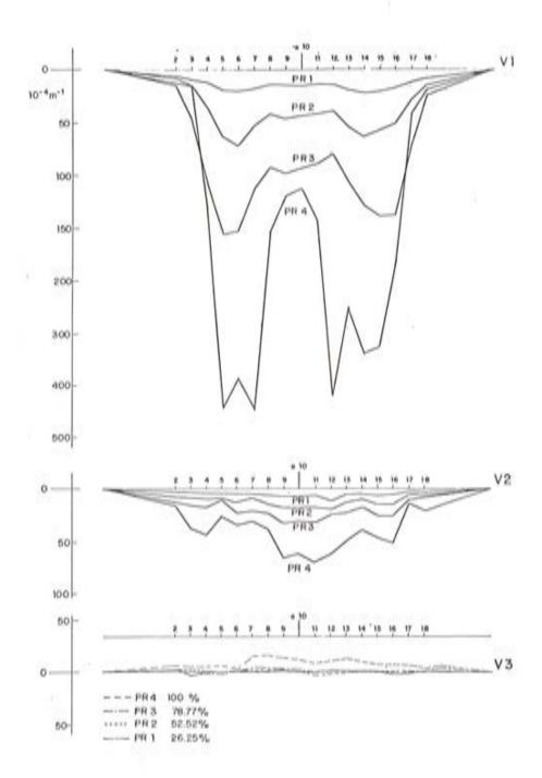
Fig. 3.13. Rotura del puente. Distribución de las rotaciones.
