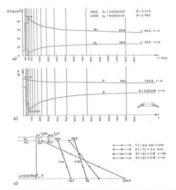
Fig. 3.3. Fluencia y retracción total. a) Variación en el tiempo de las tensiones de la viga y de la losa en la fibra de contacto; b) Variación en el tiempo de la carga de pretensado, P, y del giro de la viga en los apoyos, θ.
