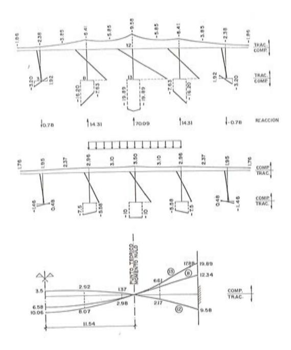
Fig. 1.30. Tablero continuo. Sobrecarga uniformemente distribuida en el centro, a) Distribución de  $\sigma_{\rm x}$  en el apoyo; b) Distribución de  $\sigma_{\rm x}$  en el centro del vano; c) Distribución de  $\sigma_{\rm x}$ , a lo largo de la luz, en los nudos  $\odot$ ,  $\odot$  y  $\odot$ .
