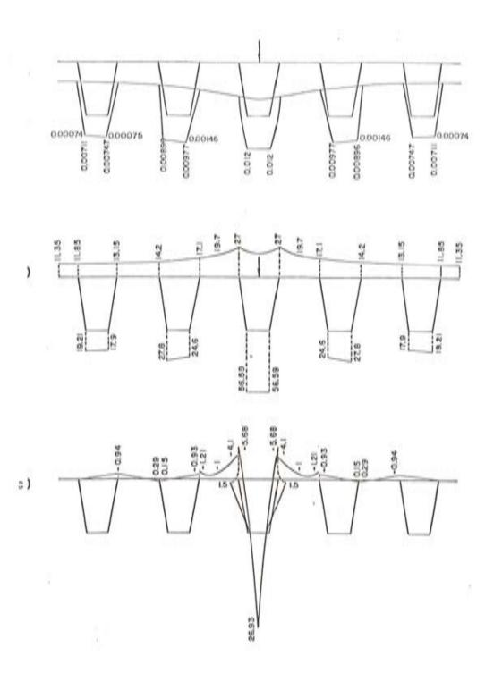
Fig. 1.34. Esfuerzos y tensiones en el centro de la luz. a) Corrimientos; b) Tensiones longitudinales  $\sigma_x$ ; c) Momentos flectores transversales  $M_v$ .
