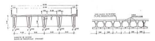
Puentes de vigas prefabricadas
