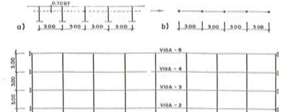
Fig. 1.38. Paso de estructura real a emparrillado plano. a) Sección transversal real; b) Sección emparrillado; c) Planta emparrillado.
