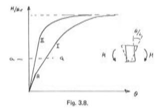
ahí en adelante siguen una respuesta proporcional, correspondiente al trabajo de la armadura de tracción en fase elástica; y a partir del momento de la pérdida de la fase elástica de la armadura, la ley de momentos-curvatura deja de ser proporcional, hasta alcanzar la rotura del hormigón. Este esquema de funcionamiento puede variar con la cuantía de armadura en la viga; pero para los efectos de lo que buscamos, nos sirve. (Curva I, figura 3.8).
