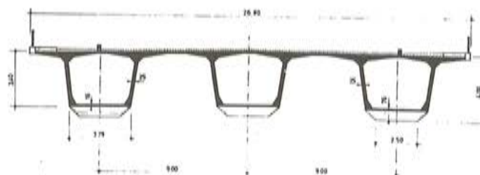
Fig. 7.13. Sección transversal del puente Saint-Jean en Bordeaux.
