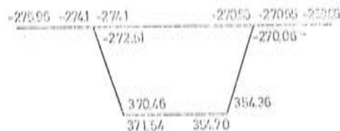
a) Tensiones normales longitudinales (t/m²)
