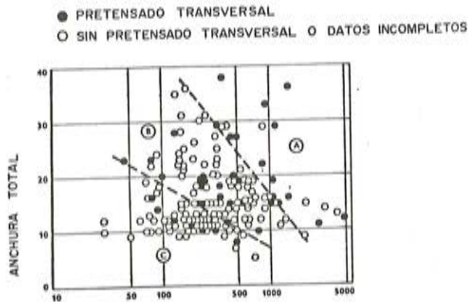
Fig. 7.17. Uso de pretensado transversal.
