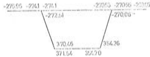
a) Tensiones normales longitudinales (t/m 2 )
