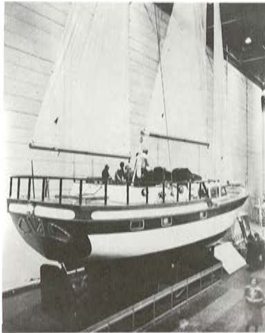
Fig. 14: Yate construido con ferrocemento en Alemania.
