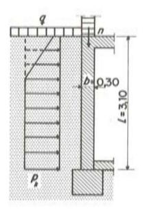
Fig. 8. Ejemplo de elemento, con consideración de la esbeltez.
