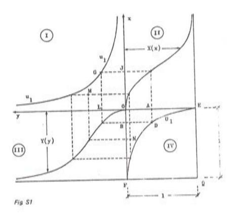
Sea, figura S 1, OEQF un cuadrado de lado unidad y OJx y OLy los ejes sobre los cuales se llevan, respectivamente, los valores de las variables x e y. El cuadrante I expresa, me diante el trazado de la hipérbola u<sub>1</sub> la condición de que u<sub>1</sub> = x y, siendo u<sub>1</sub> una constante que puede tomar diversos valores, tantos como hipérbolas pueden dibujarse en ese cuadrante.
