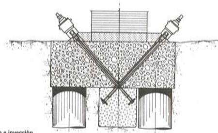
Fig. 10.—Tesado e inyección.
