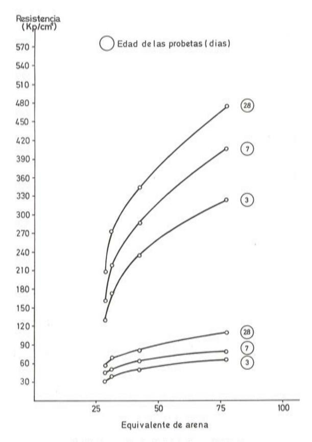
Fig. 16.- Curvas resistencia - Equivalente de arena (15% finos)
