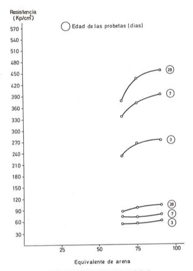
Fig. 14.— Curvas resistencia - Equivalente de arena (5% finos)
