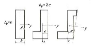
Fig. 6. Anchura virtual de una sección
