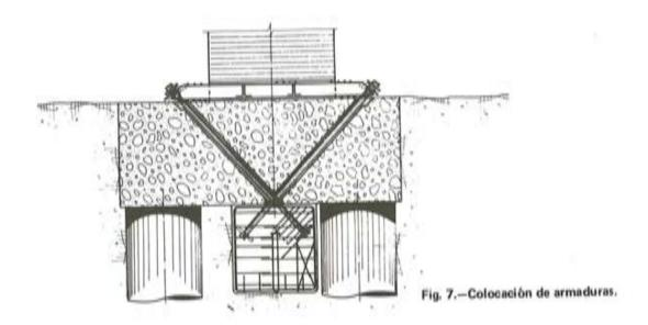
Las armaduras de la losa superior del encepado que sirve para alojar a los anclajes activos.
