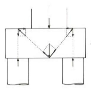
Fig. 11.-Forma de trabajo de una zapata tipo.
