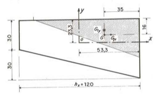
Fig. 4, Sección eficaz en compresión excéntrica.
