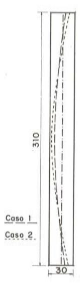
Fig. 9. Líneas ficticias de presión del elemento de la figura 8, con consideración del pandeo.
