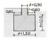
Fig. 10. Cimiento del elemento de la figura 8,
