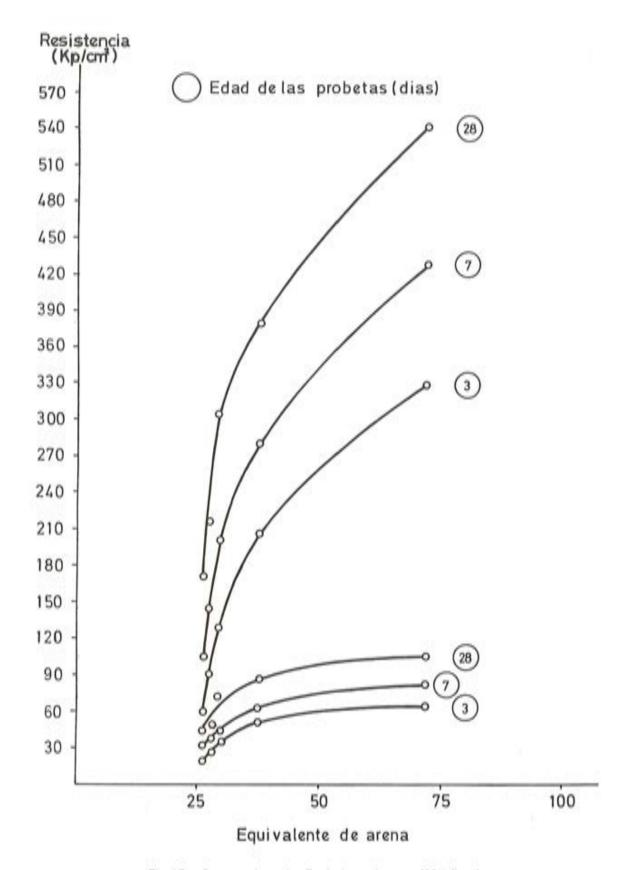
Fig. 17.- Curvas resistencia - Equivalente de arena (20% finos)
