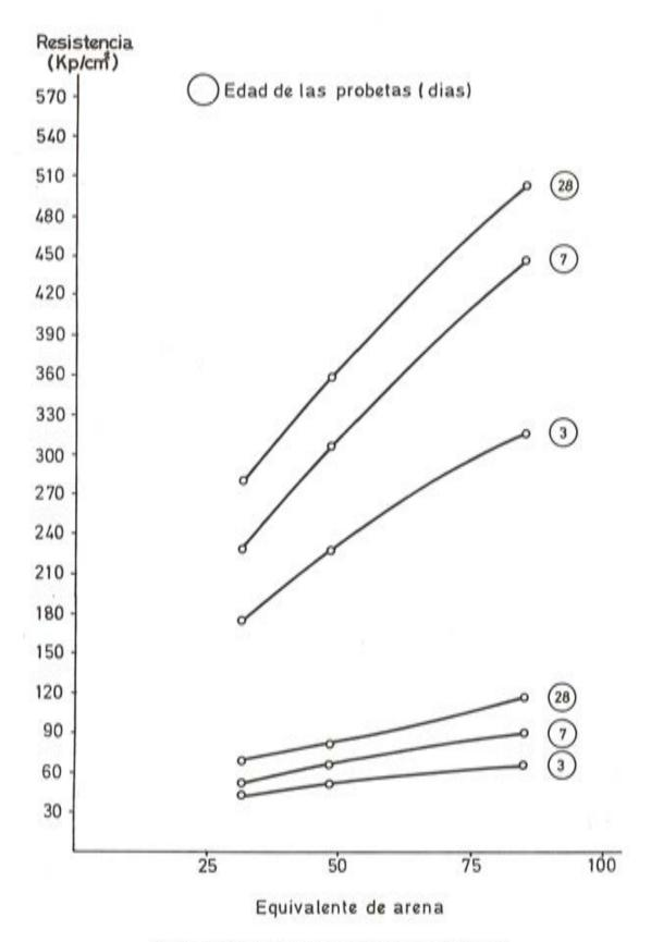
Fig. 15.- Curvas resistencia - Equivalente de arena (10% finos)
