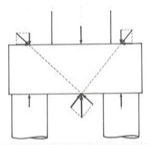
Fig. 1.—Sistema nulo de fuerzas externas aplicado sobre una zapata tipo
