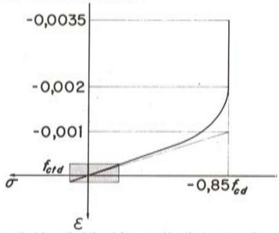
Fig. 3. Diagrama tensión-deformación del hormigón con consideración de tracciones. Punteada la zona aplicable,
