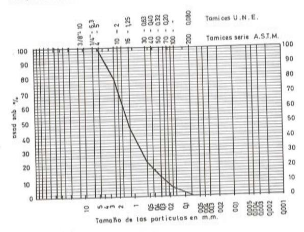
Fig. 3.— Arena original lavada y menor de 5 mm
