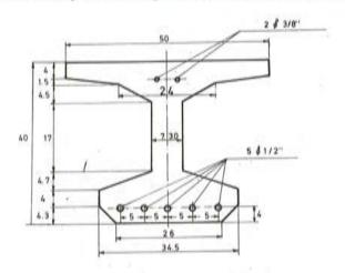
FIGURA 1. - Sección transversal de la viga
