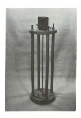
Fig. 3. Probeta de alambre tesada, sujeta al bastidor.
