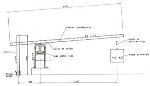
FIGURA 3 a.- Dispositivo de carga (Vista lateral)
