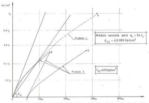
FIGURA 2.- Procesos de carga y descarga realizados en la probeta de hormigón
