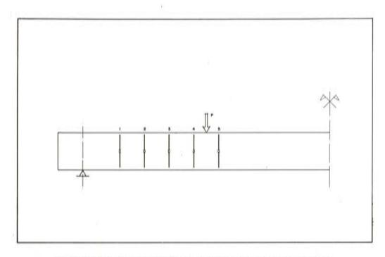
Fig. 3. Esquema de disposición de bandas extensometricas en los estribos.
