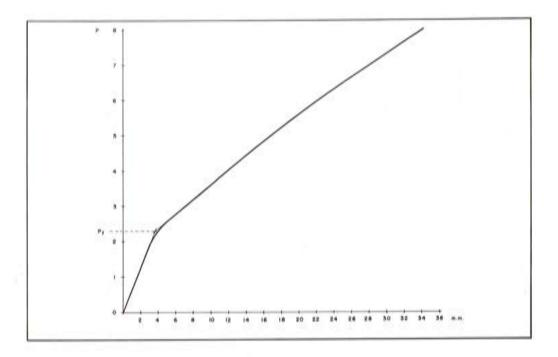
Fig. 4. Diagrama carga/flecha sección centro-luz viga 1.
