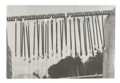
Fig. 2. Probetas de alambre de pretensado expuestas a la corrosión atmosférica.
