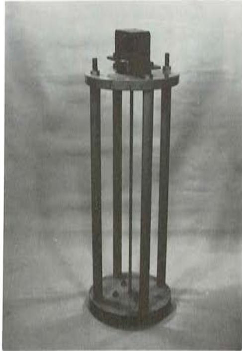
Fig. 3. Probeta de alambre tesada, sujeta al bastidor.
