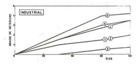
Fig. 6. Grado de corrosión para probetas de alambre de pretensado tesadas.
