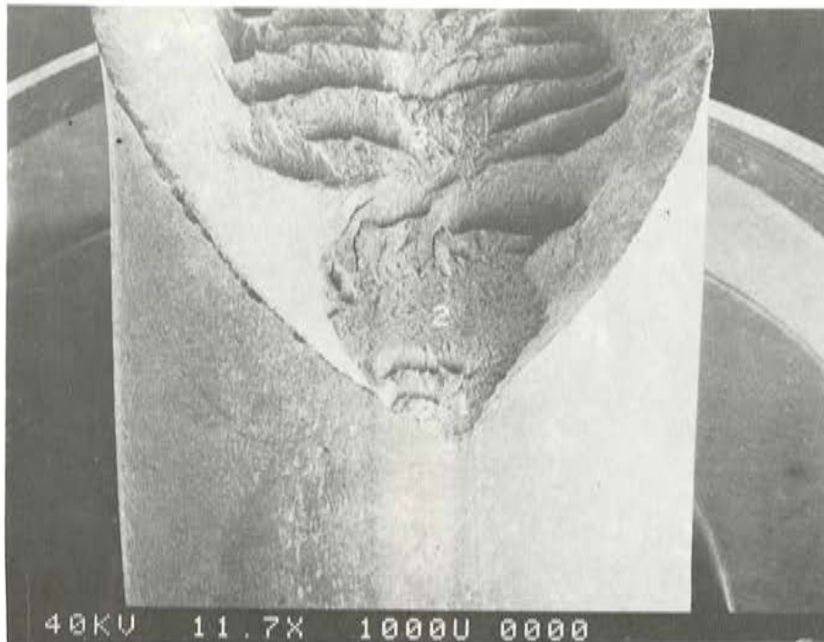
Fig. 3. Fractura en tracción lenta.
