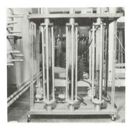
Fig. 3. Ensayo en agua destilada, de alambres.
