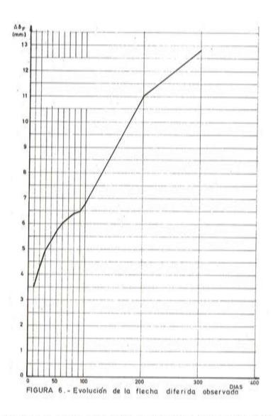
Por consiguiente, y quizás a causa de la pobreza de instalaciones con que se ha realizado el ensayo (humedad y temperaturas variable), los resultados hasta ahora encontrados no tienen valor alguno en cuanto a la determinación del parámetro  $\alpha$  correspondiente a este tipo de cemento.
