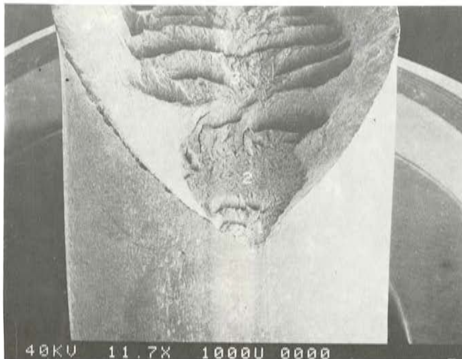
Fig. 3. Fractura en tracción lenta.
