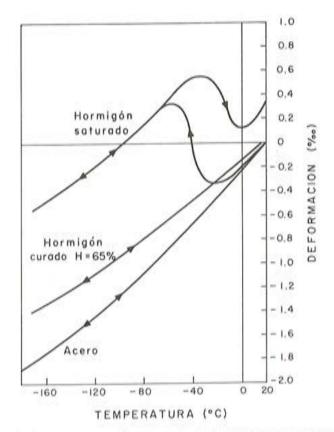
Fig. 9. Contracción al bajar la temperatura del acero y de dos hormigones con distinto contenido de humedad.
