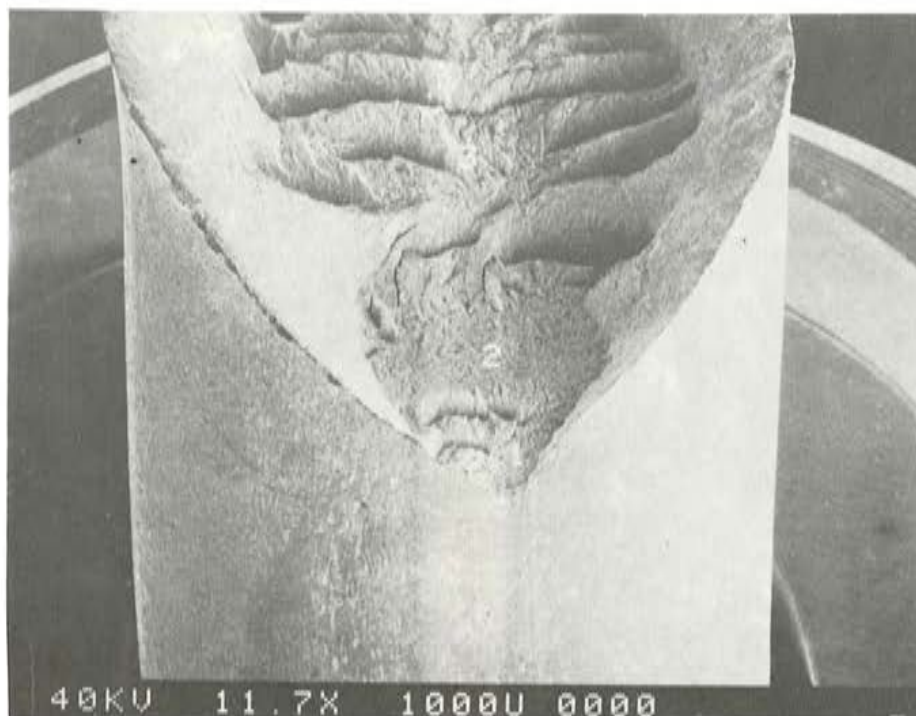
Fig. 3. Fractura en tracción lenta.
