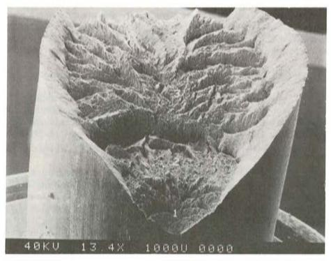
Fig. 1. Fractura en NH<sub>4</sub>SCN.
