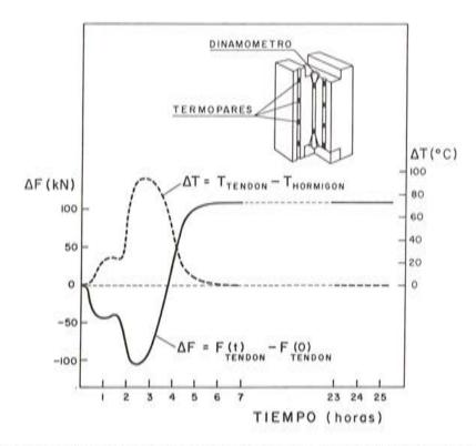
Fig. 12. Variación de la fuerza de pretensado con el enfriamiento, debida a variaciones en la contracción del acero y del hormigón, en un ensayo de un elemento estructural de hormigón pretensado.
