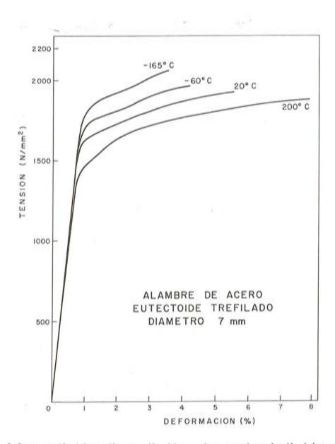
Fig. 6. Curvas tensión-deformación a tracción, del acero de pretensado, en función de la temperatura.
