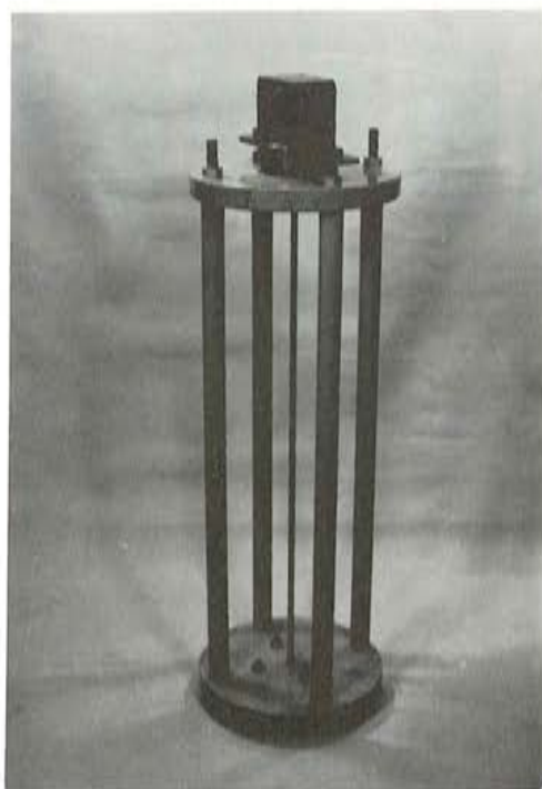
Fig. 3. Probeta de alambre tesada, sujeta al bastidor.
