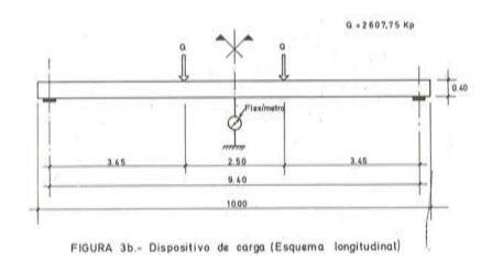
Al ser el objetivo de este ensayo la comparación entre flechas elásticas y diferidas medidas, con las teóricas calculadas a partir de la EP-80 (o del Código Modelo del C.E.B.), se precisaba concretar a que carga eran debidas aquellas. La viga hasta ahora descrita, soporta las acciones y deformaciones impuestas de:
