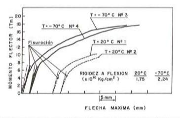
Fig. 13. Resultados experimentales de ensayo de vigas de hormigón pretensado, a bajas temperaturas.
