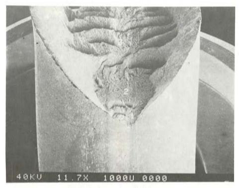
Fig. 3. Fractura en tracción lenta.
