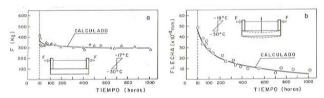
Fig. 14. Resultados experimentales y predicción teórica de la fluencia, a bajas temperaturas, de un elemento estructural de hormigón pretensado.
