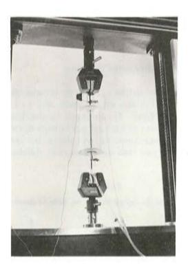
Fig. 4. Ensayo de tracción lenta en medio corrosivo.
