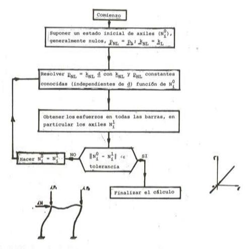
Fig. 3. Cálculo no lineal elástico de la estructura. (El valor λ es conocido).
