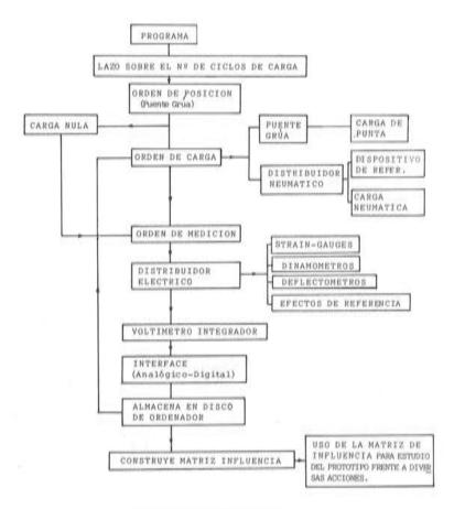
Fig. 5. Proceso de ensayo
