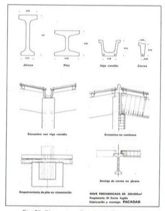
Fig. 35, Elementos y Detalles de Estructura.
