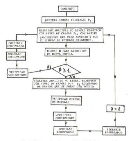
Fig. 8. Cálculo no lineal elasto-plástico (Método incremental)
