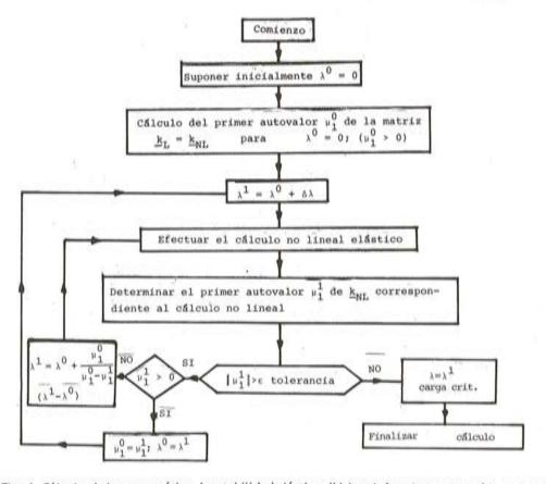
Fig. 4. Cálculo de la carga crítica. Inestabilidad elástica. (Valor de λ a determinar; Δλ es dato)
