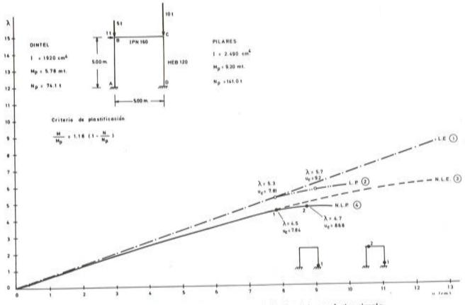
Fig. 7. Desarrollo del movimiento horizontal del dintel de un pórtico simple
