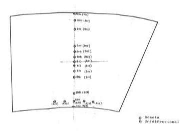
Fig. 11. Zeughausbrucke - puntos de medida
