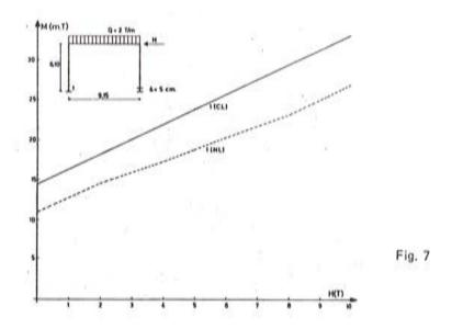
Para la sección estudiada, se observa que, para cualquier valor de la carga horizontal (incluso para H = 0), se produce una redistribución de esfuerzos, dado que el momento flector producido en la citada sección por la combinación de la carga repartida y el desplazamiento, supera el momento de fisuración; con lo que entra en la fase no lineal del diagrama M-C. Para el caso de H = 0, la redistribución de momentos en la sección estudiada es del 17% del valor obtenido según el cálculo lineal.
