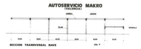
Fig. 43. Sección transversal,
