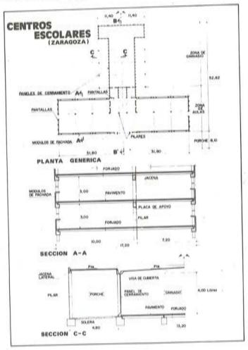
Fig. 14. Planta y secciones tipo.
