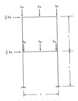
Fig. 9. Pórtico de dos pisos
