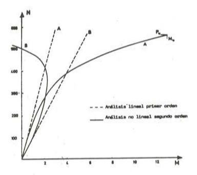
Fig. 14. Esfuerzos obtenidos en el análisis del ejemplo núm. 3
