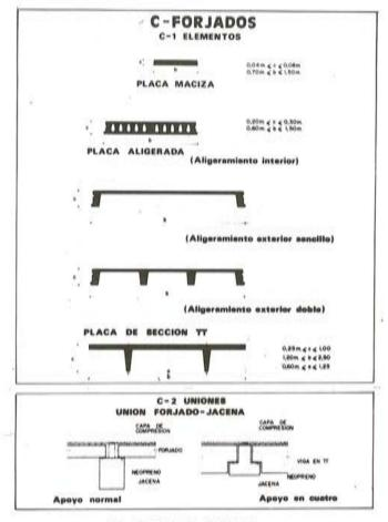
Fig. 3. Tipos de Forjados.
