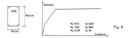
que se obtienen diagramas definidos por puntos, a los que posteriormente se ajustan diagramas trilineales. (Fig. 6).
