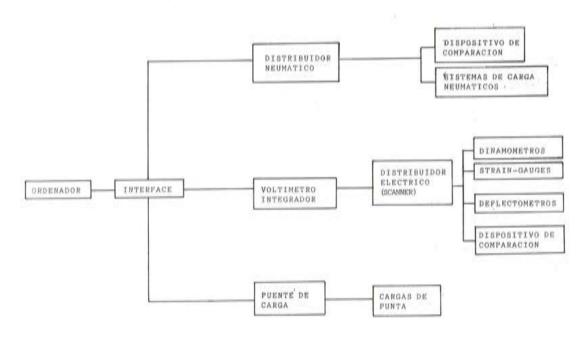
Fig. 4. Descripción del laboratorio de ensayo de estructuras, en modelo reducido
