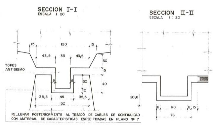
Fig. 6. Topes de sujeción frente al sismo, en pilas
