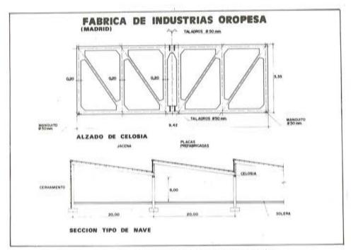
Fig. 44. Sección y detalle de celosía.
