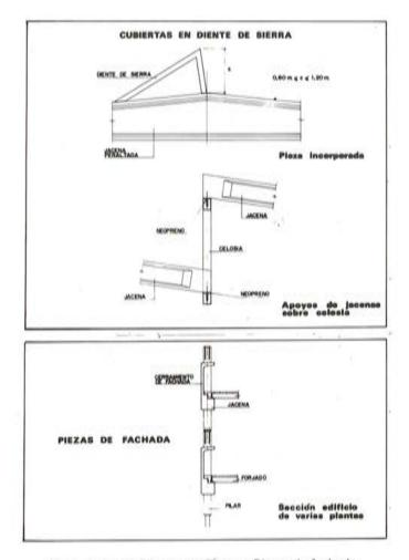
Fig. 5. Tipos de Dientes de Sierra y Piezas de fachada.
