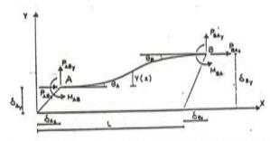
Fig. 2. Fuerzas en los extremos de barra procedentes del cálculo lineal
