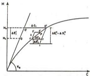
Fig. 4. Diagrama Momento-curvatura de una sección arbitraria. Proceso iterativo
