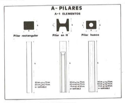
Fig. 1, Tipos de Pilares.
