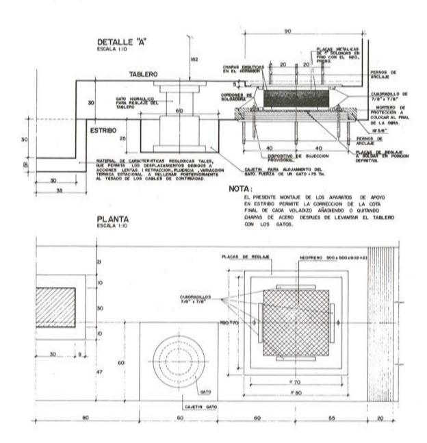
Fig. 8, Disposiciones constructivas para permitir la corrección altimétrica
