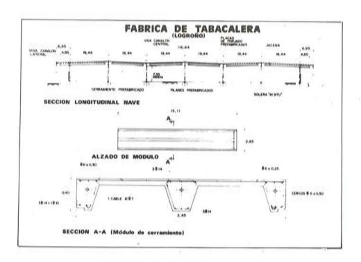
Fig. 38. Sección y Panel de cerramiento.
