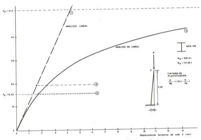
Fig. 6. Desplazamiento horizontal del extremo libre de una ménsula.
