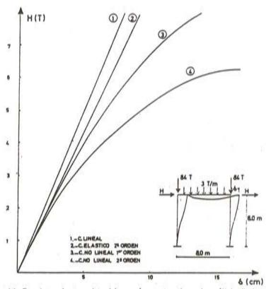
Fig. 11. Desplazamientos obtenidos según cuatro tipos de análisis distintos
