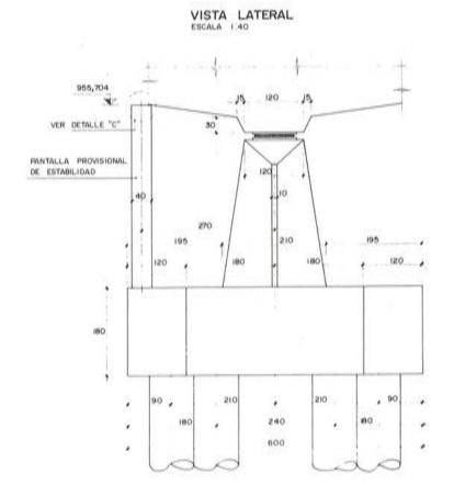
Fig. 12. Sistema de estabilidad provisional durante construcción
