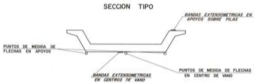
Fig. 11. Puntos de medida, en prueba de carga.
