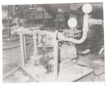
Fotografía 12. Puesto de operación de la inyección al lado de los depósitos.
