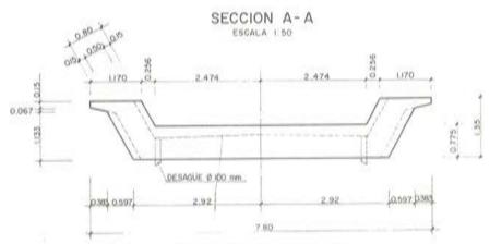
Fig. 4. Sección sobre estribos
