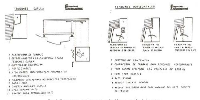
Fig. 8. Esquema de los sistemas de sujección y elevación de los gatos.
