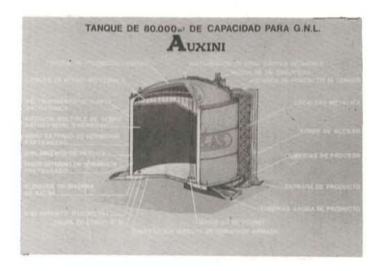
El depósito consiste en dos muros concéntricos de hormigón pretensado, sustentados por una cimentación directa de hormigón armado, fondo de acero, techo suspendido y cúpula de hormigón armado. Entre ambos recipientes se ha dispuesto un sistema de aislamiento. Este depósito lleva incorporada una torre de acceso y soporte de tuberías de proceso y demás elementos de instrumentación. Las penetraciones se efectúan todas por la cúpula, excepto la salida de producto que tiene lugar por el fondo.
