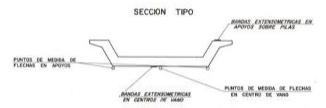
Fig. 11. Puntos de medida, en prueba de carga.
