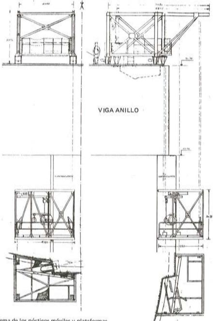
Fig. 7. Esquema de los pórticos móviles y plataformas.
