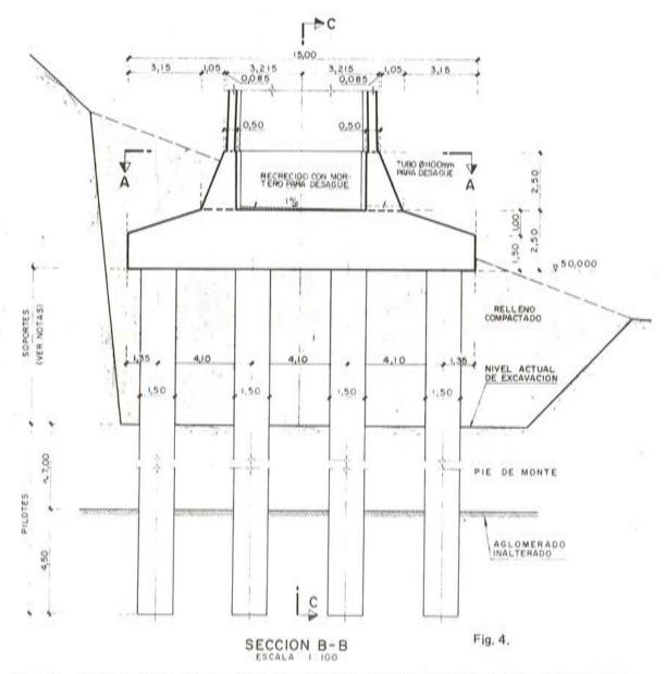
que por condicionantes de la luz lateral, requirió construirse sobre cimbra convencional. Sobre las pilas laterales, se construyó una cabeza de pila excéntrica, de 7,85 m, y quince dovelas de 3,45 m. Sobre las pilas centrales, la cabeza tenía una longitud de 13,60 m y se hormigonaron doce dovelas de 3,20 m y dieciséis de 4,10 m. El cierre entre los diversos tramos de tablero, se realizó avanzando simétricamente desde estribos al centro del puente, mediante cinco dovelas de 2,60 m de longitud.
